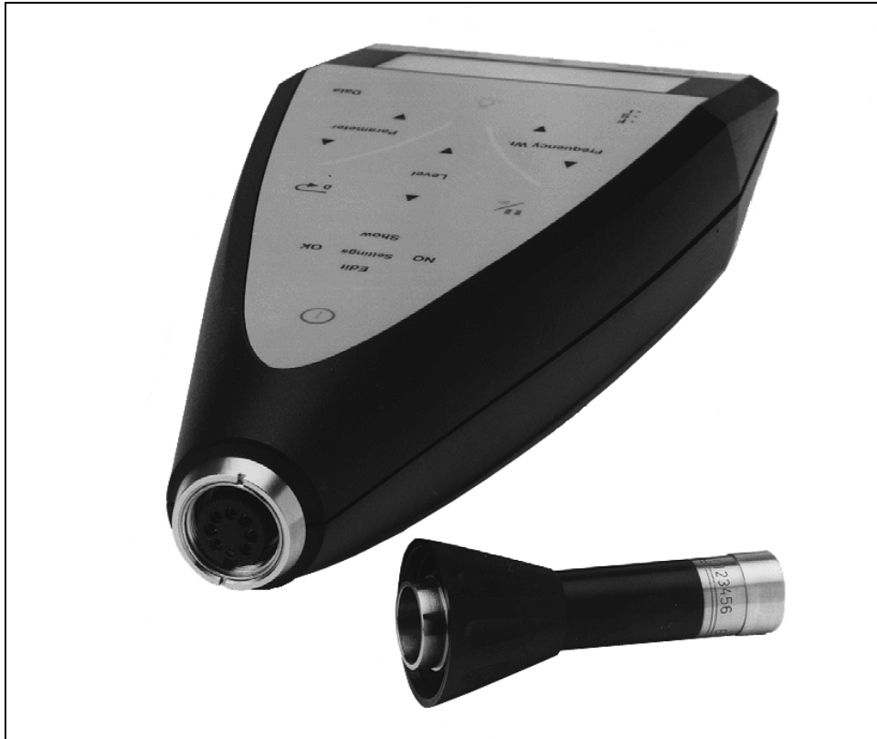
Abbildung 3: Messgerät von „Brüel&Kjaer“ Typ2236 (Quelle : Technical Documentation, German BB 0904 - 14 , August 1997)
