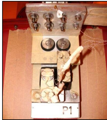
Abbildung 6-12: Vorbereitungen zur Messung mittels Maler-Krepp-Klebeband
