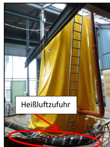
Abbildung 6-3: Umluftsystem Ansicht von außen
