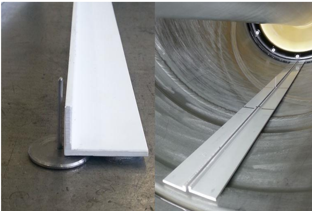
Abb. 58: Links: Eine der drei Nadeln (im Bild 30mm) auf der Scheibe mit der noch unbearbeiteten PVC-Schiene; Rechts: Bearbeitete Schiene mit Positionsmarkierungen und Nadel (im Bild 40mm) auf Position 2 im Prüfaufbau
