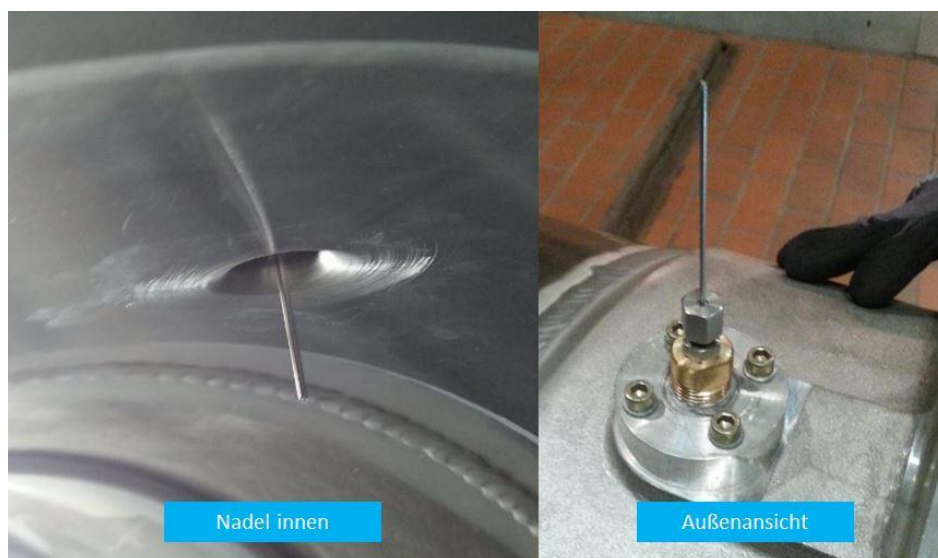
Abb. 44: Detailansicht der von außen verstellbaren Nadel
