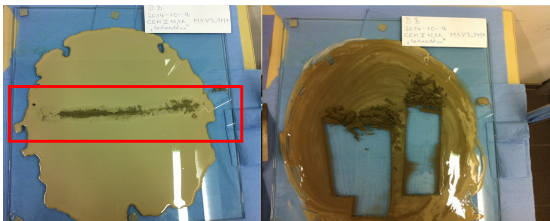
Bild 4-28 zweite FM-Zugabe (FM 144); im rechten Bild sind Blutungserscheinungen erkennbar
