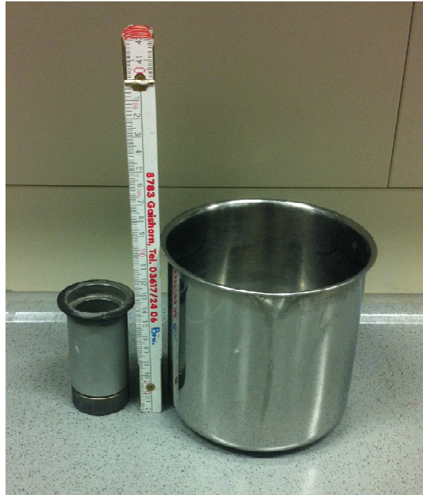
Bild 3-7 Messbehälter für das Rheometer (links) und Mischbehälter für Handrührer (rechts)
