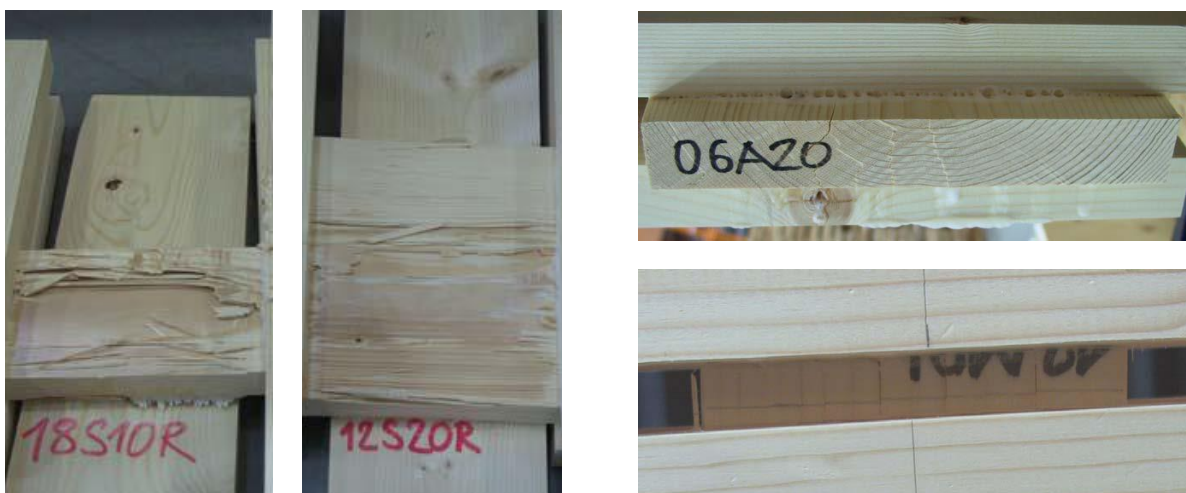
Abb. 1.32: Rollschubversagen (links) und Schubversagen (rechts) aus Wallner (2004)
