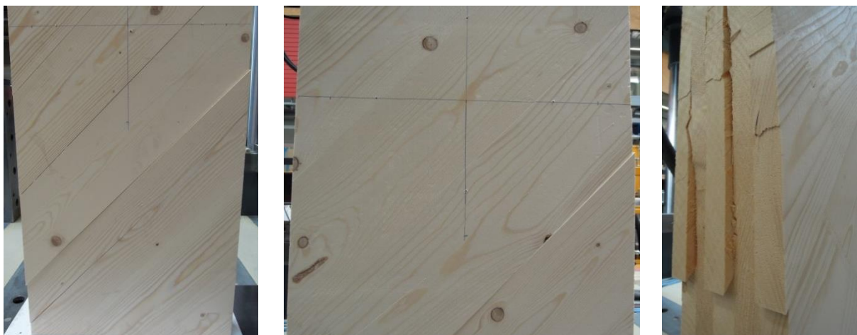
Abb. 3.8: Schubbrüche in den Längslagen der Prüfkörper B_3s_02 und E_5s_02
