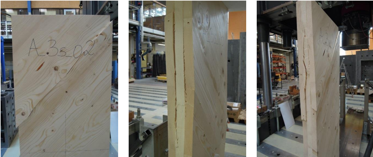
Abb. 3.18: Bruchbilder der Serie A: Schubbruch im Brettquerschnitt der Längslage (links); einzelne (mittig) bzw. mehrere (rechts) Längsschubbrüche in der Querlage
