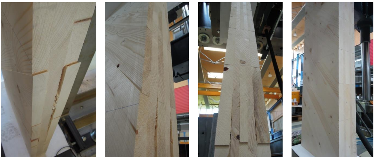
Abb. 3.4: Verformungen in mehreren Scherfugen der Prüfkörper B_3s_01, E_5s_05, I_5s_04 und J_5s_02
