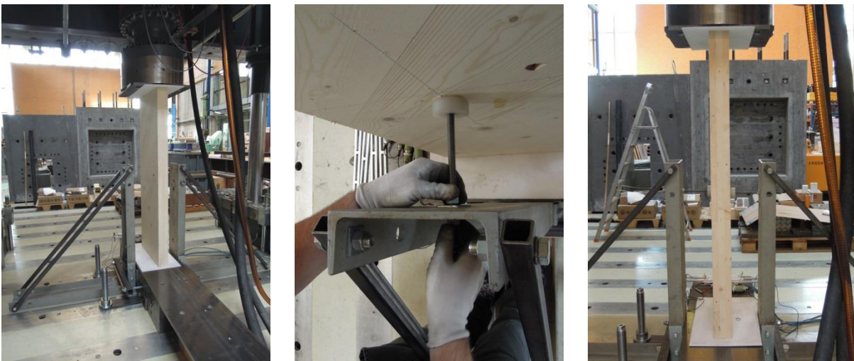
Abb. 2.13: Knickhalterung: Positionierung der beiden Stahlrahmen (links); Anbringen der Gewindestangen (mittig); Prüfkörper mit montierter Knickhalterung (rechts)
