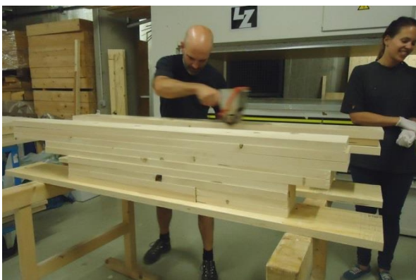
Abb. 2.9: Herstellung der Serie C: Klebstoffauftrag auf die einzelnen Bretter mittels Klebstoffwalze (links); Auflegen der Bretter direkt in der Hydraulikpresse (rechts)
