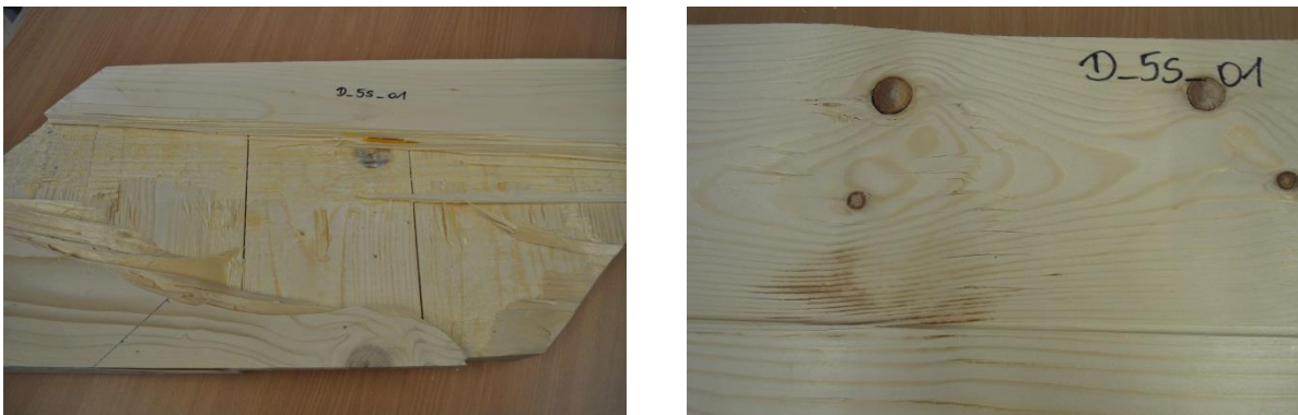
Abb. 3.16: Ablösen der Decklage (links) und Netto-Schubbruch in der Mittellage (rechts) der Serie D
