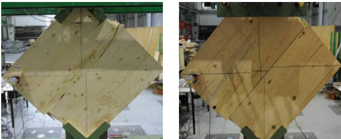
Abb. 1.29: Schubversagen parallel zur Faserrichtung und Torsionsversagen der Serie A-3 (links) und Torsionsversagen der Serie A-5 (rechts), aus Andreolli et al. (2012)
