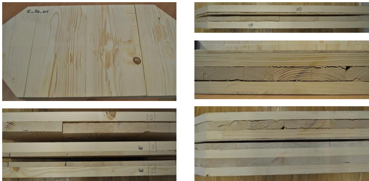
Abb. 3.7: Längsschubrisse in der Querlage: Serien E (links), B und G (rechts)
