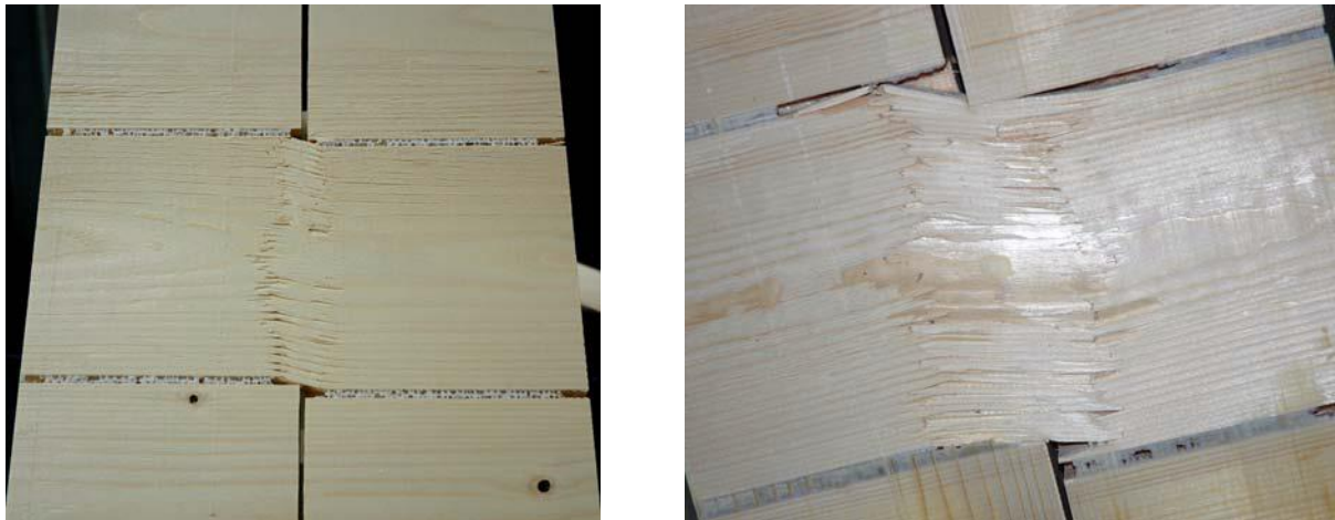
Abb. 1.36: Netto-Schubversagen der Prüfkongfiguration „EN“, aus Hirschmann (2011)
