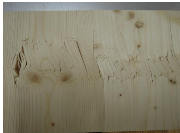
Abb. 1.42: Netto-Schubbruch der Querlagen des Prüfkörpers 2 (links) und Netto-Schubbruch der Mittellage des Prüfkörpers 3 (rechts), aus Dröscher und Brandner (2013)
