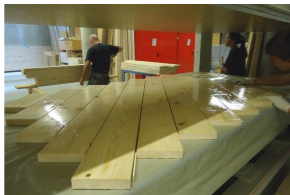
Abb. 2.9: Herstellung der Serie C: Klebstoffauftrag auf die einzelnen Bretter mittels Klebstoffwalze (links); Auflegen der Bretter direkt in der Hydraulikpresse (rechts)
