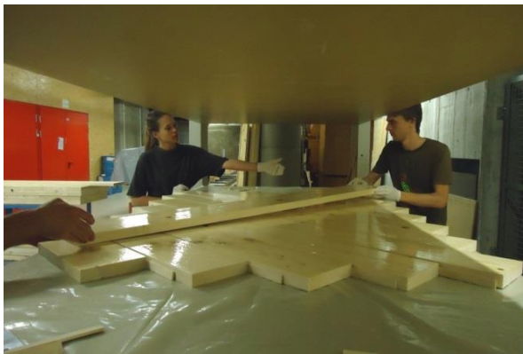
Abb. 2.10: Herstellung der Serie C: Anordnen der zweiten Lage (links); Pressvorgang (rechts)
