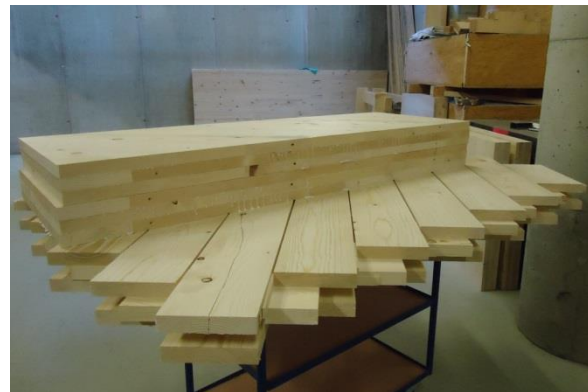
Abb. 2.8: Herstellung der Serie A: Flächige Verklebung der einzelnen Lagen (links); Fertige Prüfkörper (rechts)
