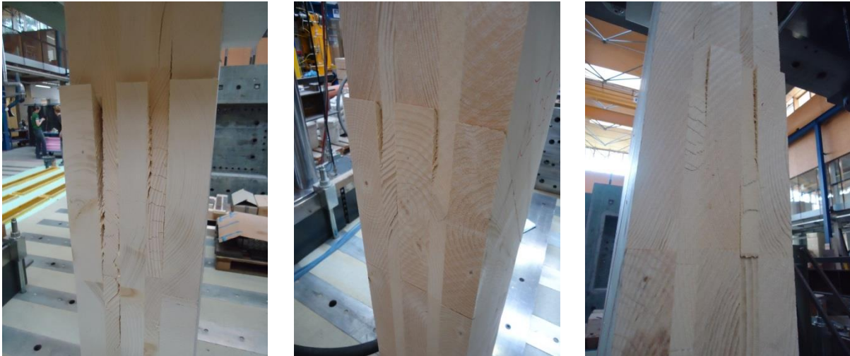
Abb. 3.5: Netto-Schubbruch der Querlagen bei Prüfkörpern ohne Fugen, ohne Seitenverklebung und mit dünnen Querlagen
