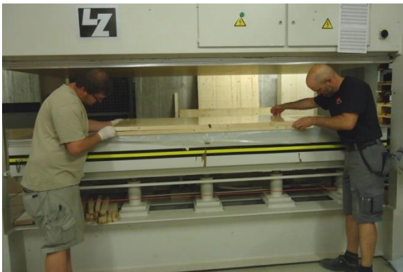
Abb. 2.8: Herstellung der Serie A: Flächige Verklebung der einzelnen Lagen (links); Fertige Prüfkörper (rechts)
