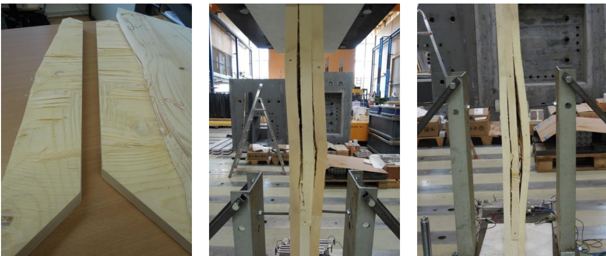
Abb. 3.19: Schubversagen in der Klebefläche im Bereich des Längsschubbruchs (links) und Ausknicken bzw. Ablösen der Decklage (mittig und rechts) der Serie A
