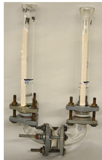
Abbildung 25: U-Rohraufbau für Osmoseversuch
