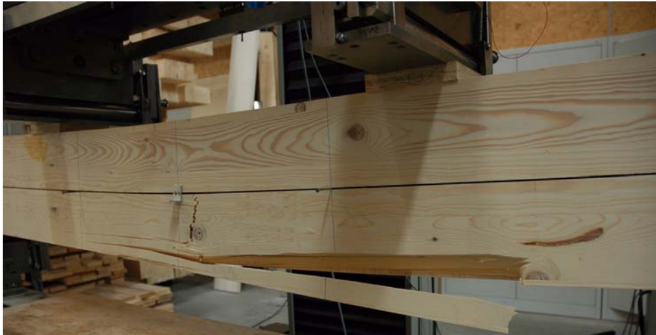
Abb. 1.30: Versagen der Zugzone bei der CUAP-Scheibenschubprüfung
