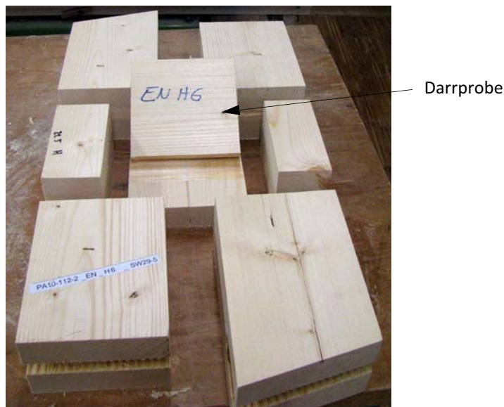
Abb. 4.4: Darrprobenentnahme am Bsp. EN_H6
