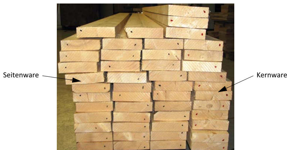
Abb. 3.1: Schritt 1: Vorsortierung der BSH-Lamellen in Seitenware und Kernware
