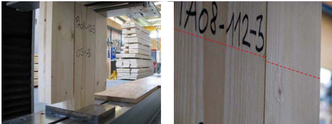
Abb. 1.38: Schubversagen am Prüfkörper der Versuchskonfiguration Jöbstl
