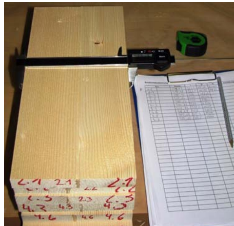
Abb. 3.9: Schritt 7: Bestimmung der Abmessungen mittels Schiebelehre
