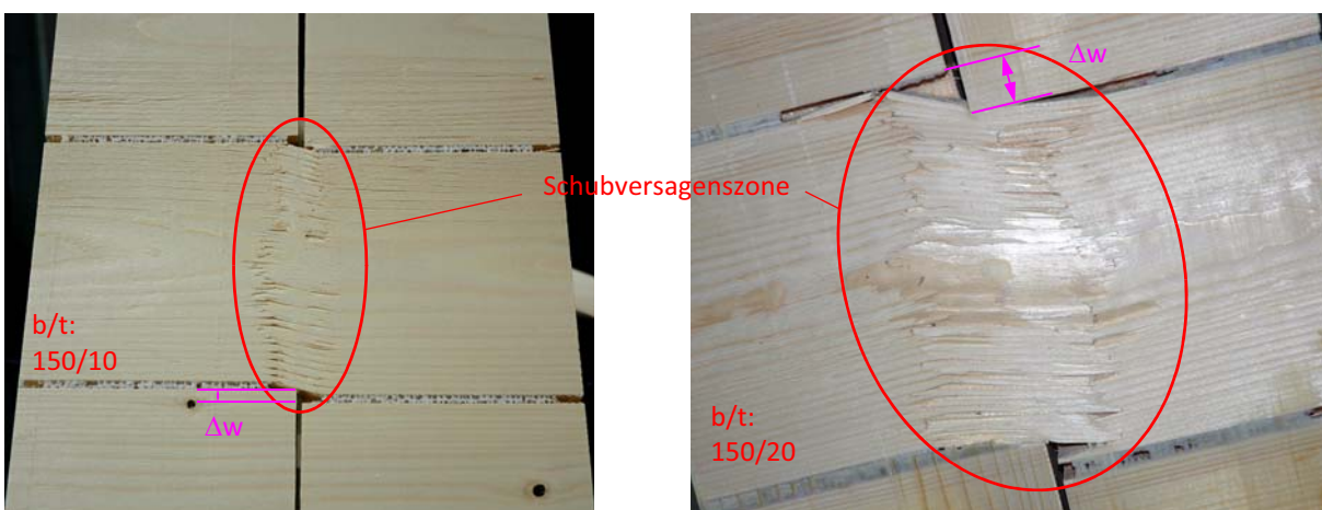
Abb. 2.6: Bruchbilder der aufgetrennten Prüfkörper
