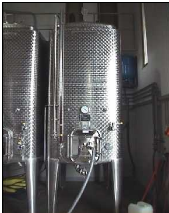
Abbildung 4: Typischer Gärtank aus Stahl (JOHNER 1998)
