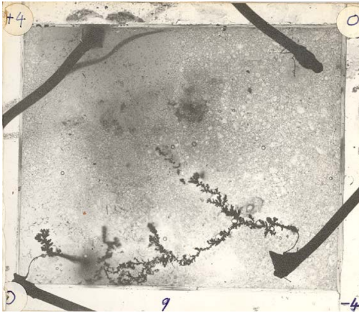
ABB. 3: ENTWICKLUNG DER »THREADS« AUFGRUND MAXIMALER SPANNUNG, ELECTROCHEMICAL EXPERIMENT, GPA
