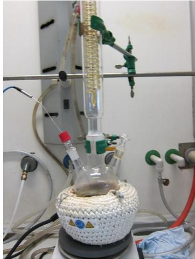
Abbildung 75: Versuchsaufbau der thermischen Vorbehandlung der WPH
