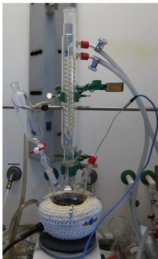
Abbildung 83: Versuchsaufbau der basischen Vorbehandlung der WPH bioCRACK
