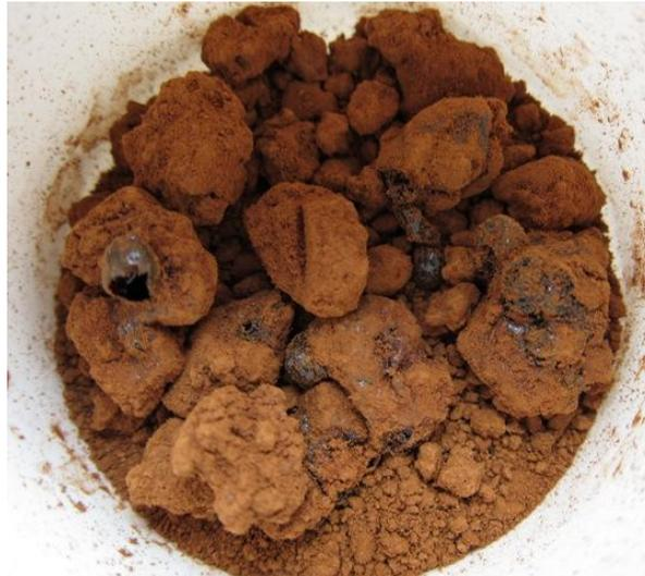
Abbildung 79: Gefriergetrockneter Feststoff der thermischen Vorbehandlung der WPH mit Luftzufuhr und Dialyse
