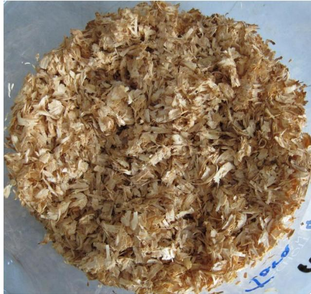
Abbildung 52: Getrocknete demineralisierte Fichtenholzspäne
