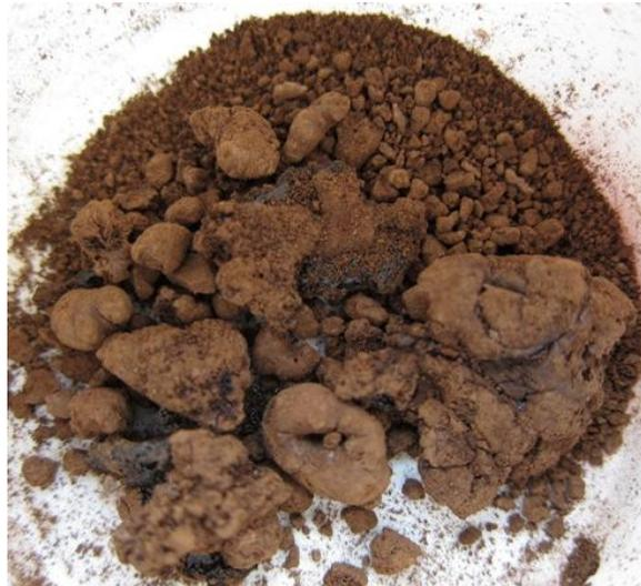
Abbildung 84: Gefriergetrockneter Feststoff der basisch vorbehandelten und dialysierten WPH bioCRACK
