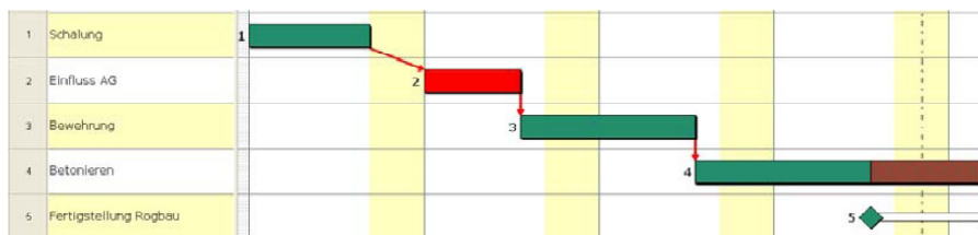
Abbildung 34: Bau-IST; anzurechnender Puffer 164
