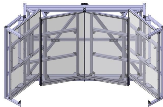
Abbildung 2.8: Aufbau Parallax Barriere
