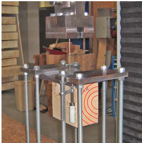
(a) Tangentiale Einschraubrichtung
