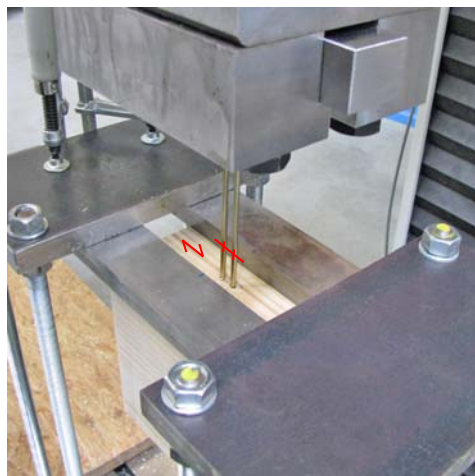
(a) Abstand a_1 parallel zur Faserrichtung
