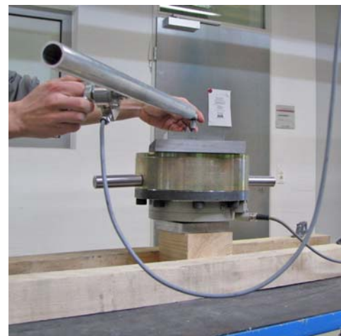
(b) Kontinuierliches Eindrehen der Schraube
