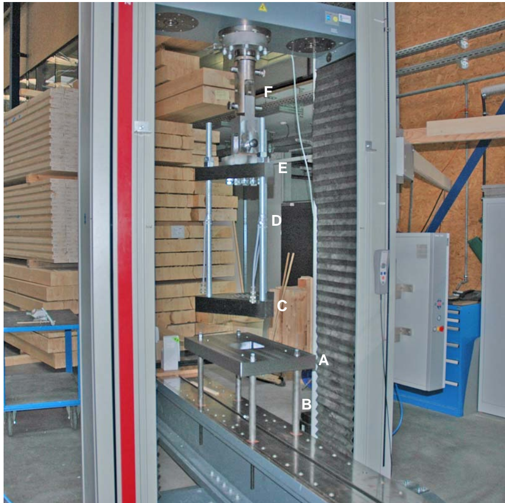
Legende: A: Lagerungsplatte, B: Gewindestangen (teilweise vorgespannt), C: Unterer Einbauteil, D: Gewindestangen mit Dehnmessstreifen, E: Oberer Einbauteil, F: Gelenkkette
