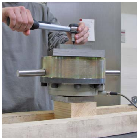
(a) Diskretes Eindrehen der Schraube
