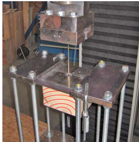
(b) Radiale Einschraubrichtung
