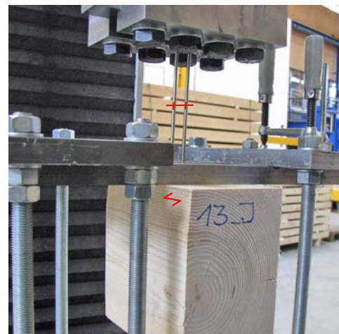
(b) Abstand a_2 normal zur Faserrichtung
