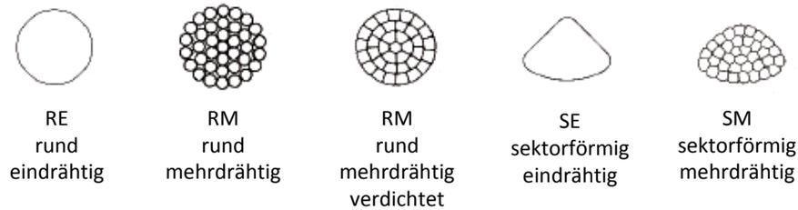
**Abbildung 4-7: Leiteraufbau von Energiekabeln [16]**
