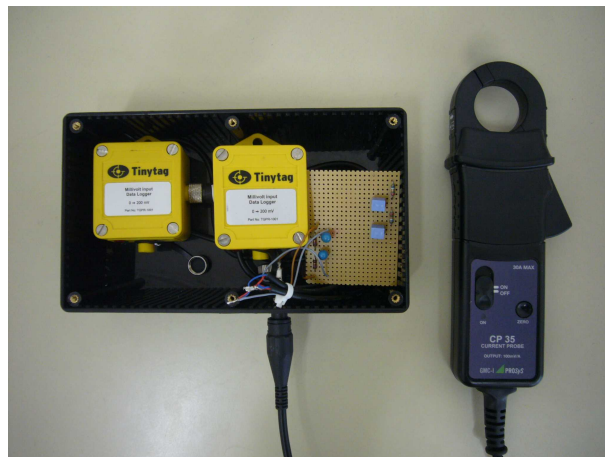
Abbildung 3.1.: Messsystem mit den verwendeten Komponenten: Stromzange, Tiefpassfilter, Datenlogger.
