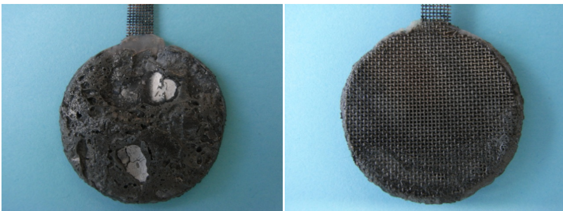
Abbildung 60 Z 6.2 mit verzinntem Stromableiter und Standardelektrolyt nach 150 Zyklen ( links: Vorderseite, rechts: Rückseite )
