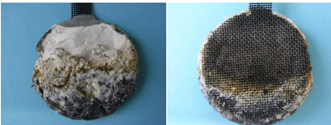
Abbildung 54 Z 5.2 mit Elektrolyt 4 nach 95 Zyklen ( links: Vorderseite, rechts: Rückseite )
