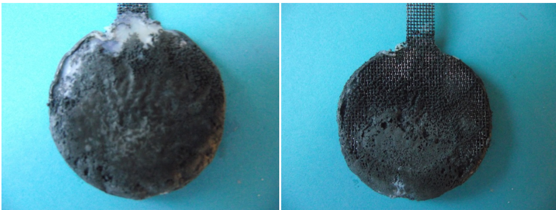
Abbildung 55 Z 10.1 mit Elektrolyt 5 nach 134 Zyklen ( links: Vorderseite, rechts: Rückseite )
