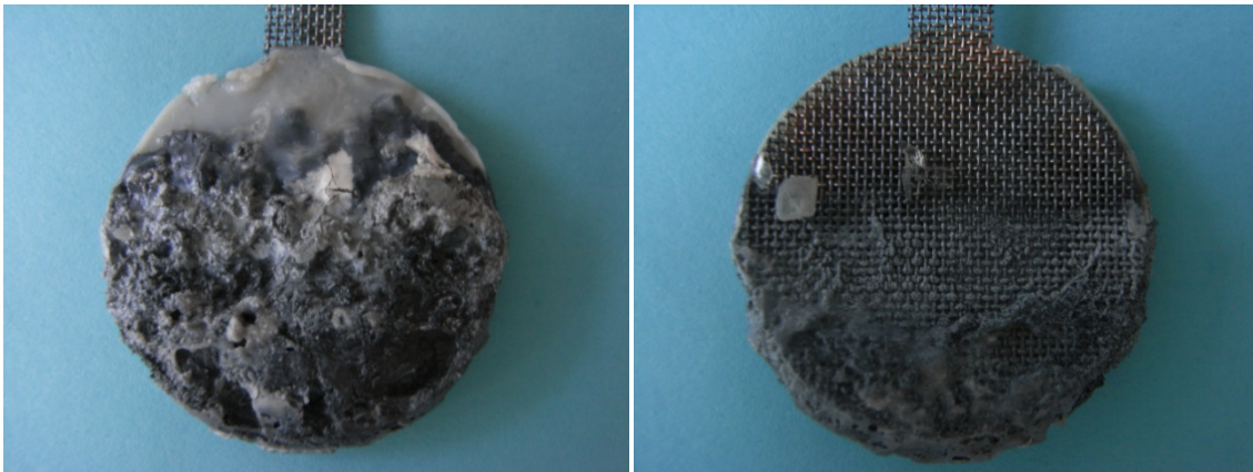
Abbildung 51 Z 5.3 mit Elektrolyt 3 nach 170 Zyklen ( links: Vorderseite, rechts: Rückseite )
