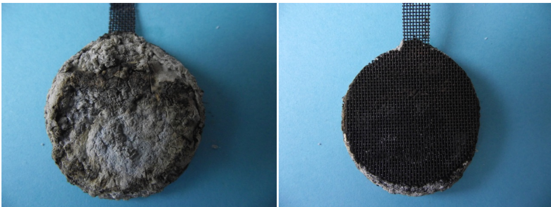
Abbildung 56 Z 10.2 mit Elektrolyt 5 nach 150 Zyklen ( links: Vorderseite, rechts: Rückseite )
