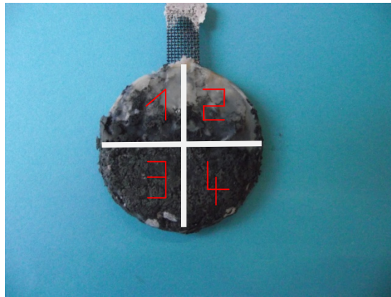
Abbildung 62 Zerteilung der Elektrode für ICP-OES Analyse
