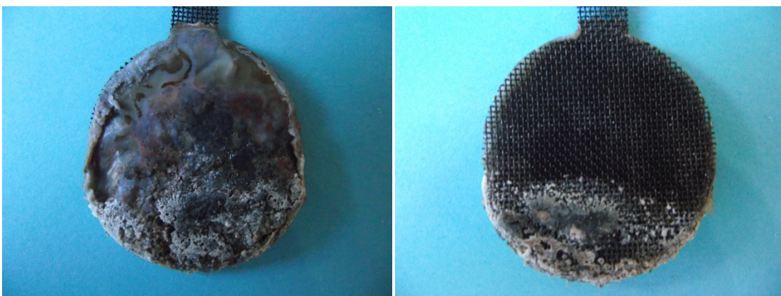
Abbildung 50 Z 9.2 mit Elektrolyt 1 nach 158 Zyklen ( links: Vorderseite, rechts: Rückseite )
