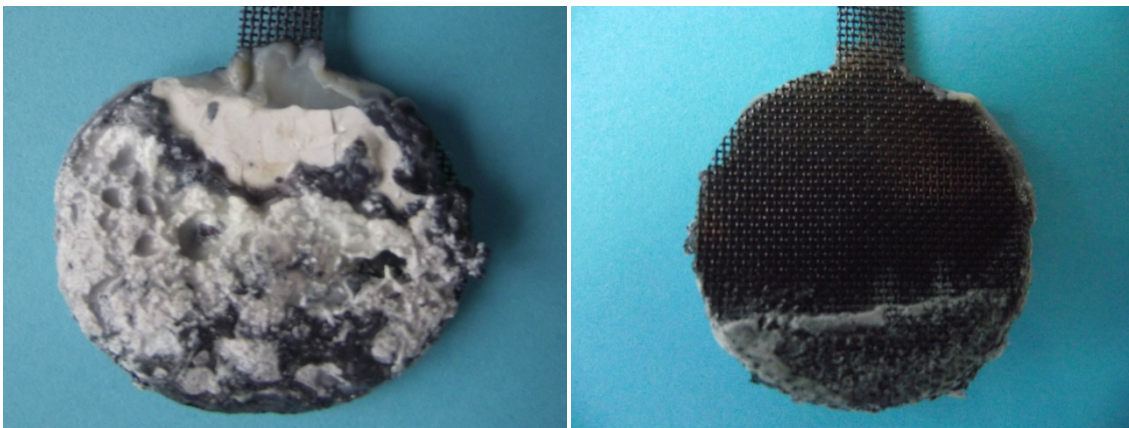
Abbildung 47 Z 8.1 mit Standardelektrolyt nach 131 Zyklen (links: Vorderseite, rechts: Rückseite)
