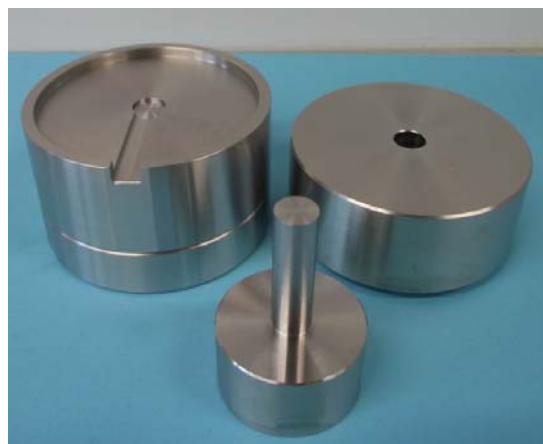
Abbildung 10 Presstempel (d = 8mm) zur Herstellung der Kleinelektroden
