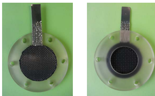
Abbildung 13 O 2 -Elektrode in Halterung ( links hydrophile Innenseite, rechts hydrophobe Außenseite )
