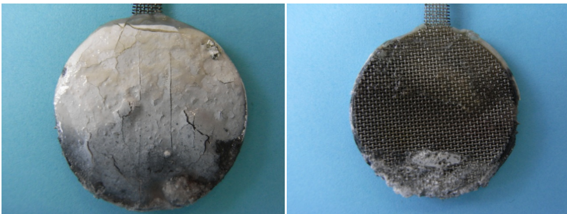
Abbildung 59 Z 6.1 mit verzinntem Stromableiter und Standardelektrolyt nach 47 Zyklen ( links: Vorderseite, rechts: Rückseite )
