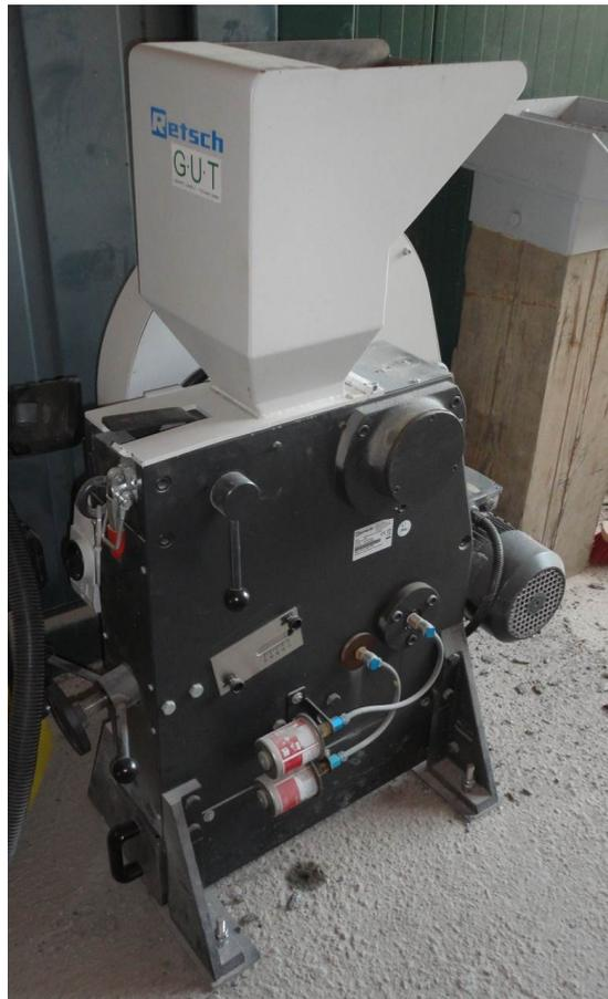
**Abbildung 3-19: Brecher vor Ort zur Zerkleinerung der Proben**
