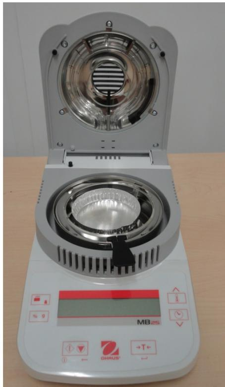
Abbildung 3-27: Restfeuchtemessgerät Ohaus MB25 (Ohaus Europe GmbH)
