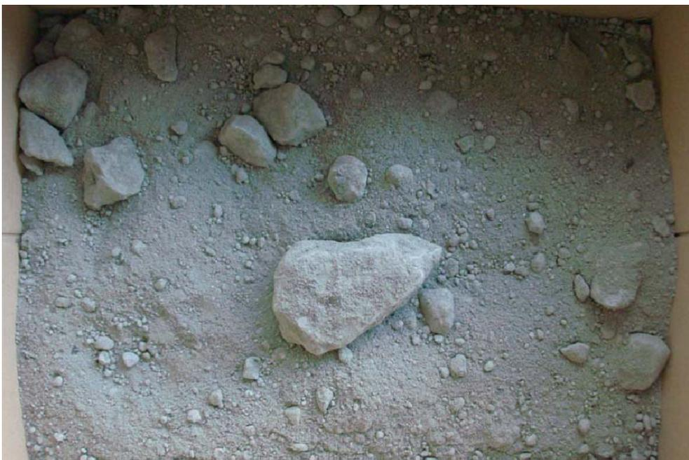
**Abbildung 3-17: Haufwerk Probe - gering verfestigter Schluffstein im neogenen Abschnitt (sandig 0 – 2 mm, vereinzelt bis 50 mm) (Bauer, 2012a)**
