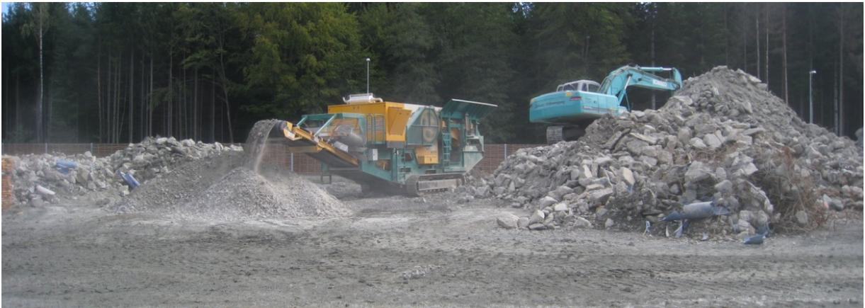
**Abbildung 3-13: Recycling von Betonabbruch EKT-Leibenfeld (ÖBB Infrastruktur AG)**
