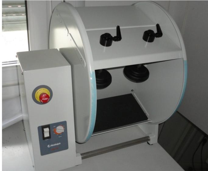
**Abbildung 3-28: Überkopfschüttler Heidolph (Heidolph Instruments GmbH & Co. KG)**
