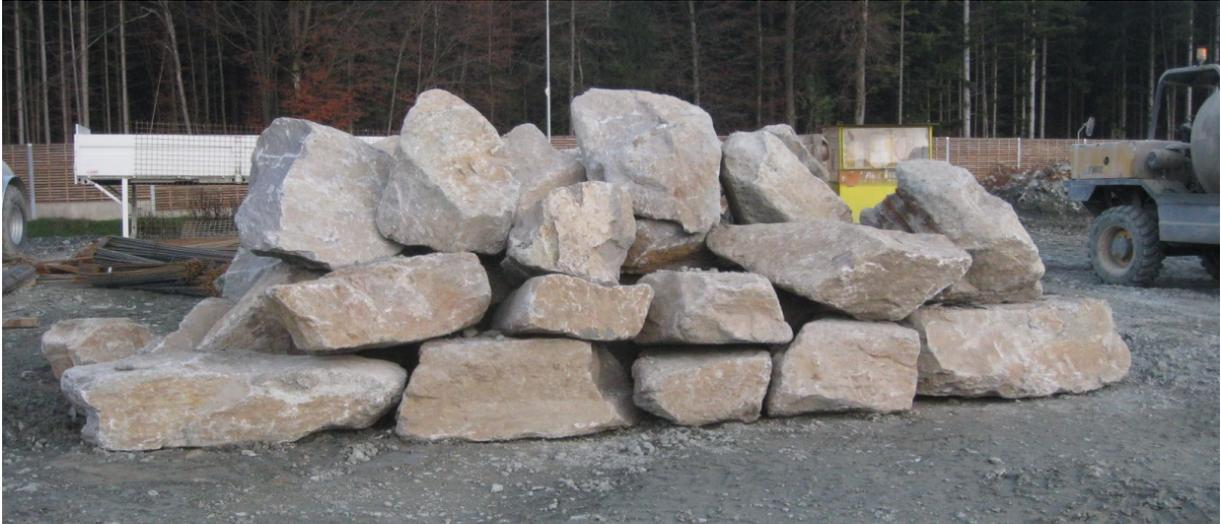
**Abbildung 3-12: Steinsatz aus kristallinem Material (ÖBB Infrastruktur AG)**
