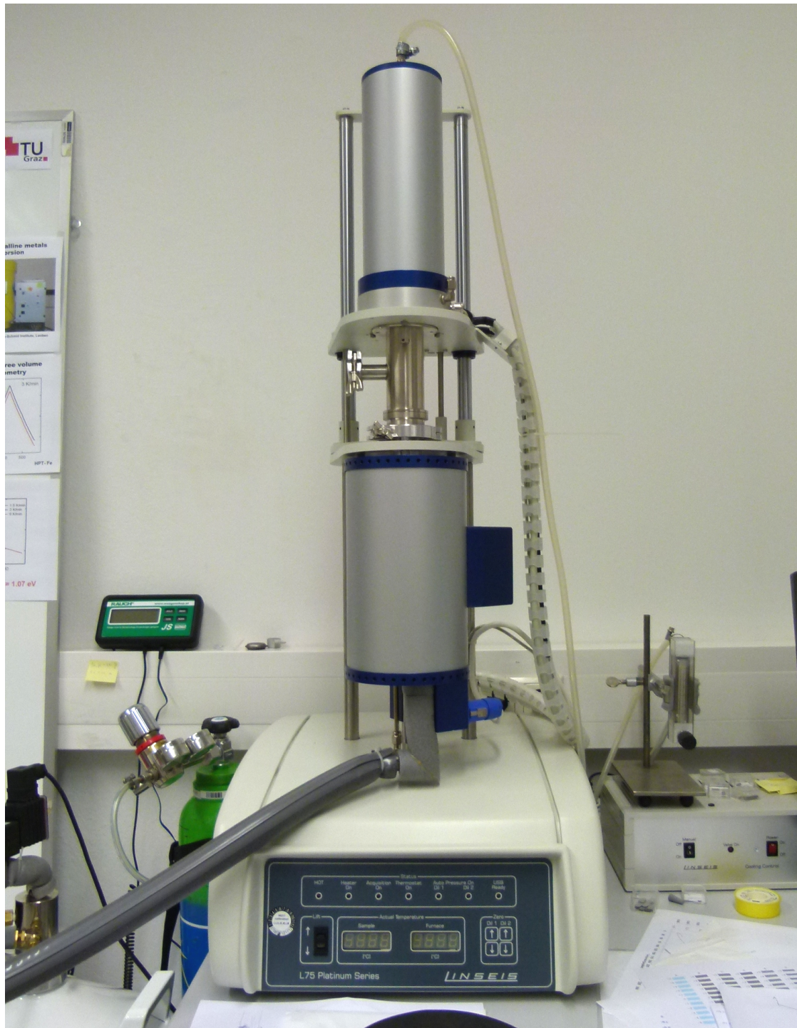
Abbildung 3.3: Das hochauflösende Differenzdilatometer Linseis DIL LV75VD. Das Dilatometer besteht aus einer Steuereinheit (unten), dem Ofen (mitig) und den Wegaufnehmern (oben). In der linken unteren Ecke des Bildes befindet sich der N_2 -Dewar und dahinter die Ar-Flasche.
