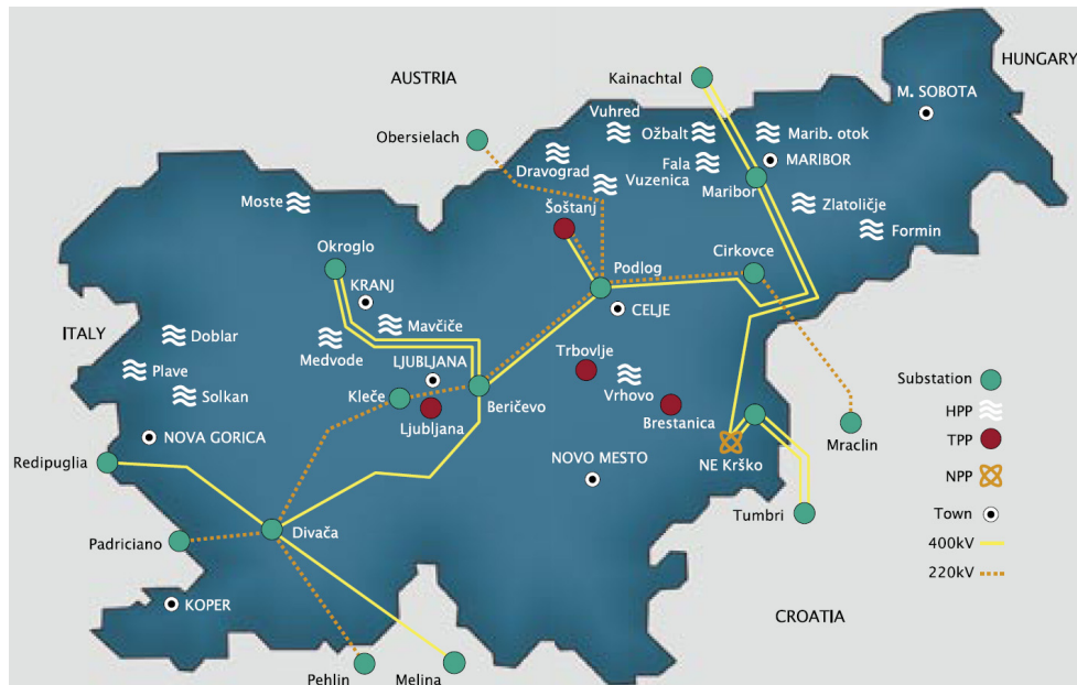
Abbildung 2-42: Hochspannungsnetz und Kraftwerke in Slowenien. Quelle: (ELES, 2007 S. 7).
