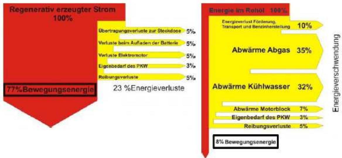
Abbildung 54: Wirkungsgrad Elektromotor und Verbrennungsmotor (vgl. Stromfahren 2012)
