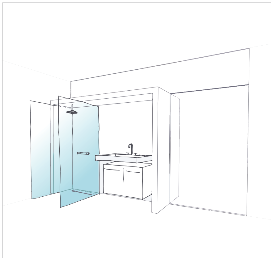
Badmodul mit Dusche und Waschtisch
