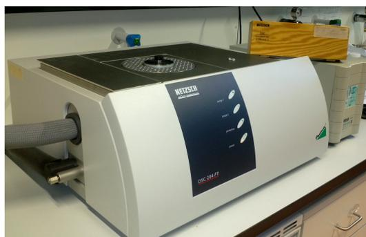
Abbildung 4.3.: Das verwendete Dynamisches Differenzkalorimeter *DSC 204 F1*.
