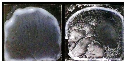
Abbildung 6.41.: Fotos von Ibuprofen-Polystyrol-Tropflaminaten nach 13 Wochen. Links 2 Gew.-% Ibuprofen und 2 Gew.-% Polystyrol auf Glassubstrat, rechts 2 Gew.-% Ibuprofen auf zuvor ausgehärtetes 2 Gew.-%iges Polystyrol.
