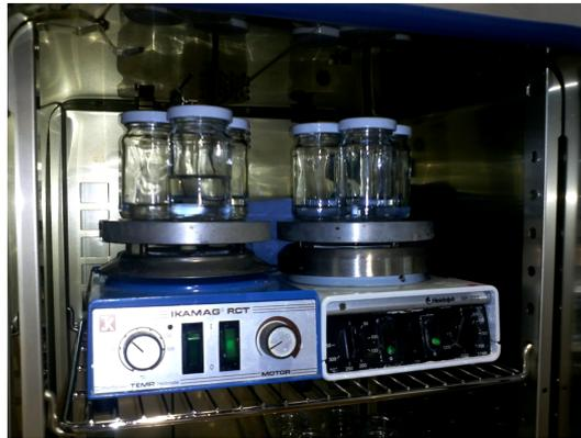
Abbildung 5.4.: Geräteaufbau für die Freisetzungstests. Zu sehen sind die Glasgefäße mit Schraubdeckel in denen die Lamine liegen. Die Glasgefäße stehen auf einem Magnetrührer innerhalb des Wärmeschanks. Die kleinen Magnetrührstäbchen sind in der Abbildung nicht zu erkennen.
