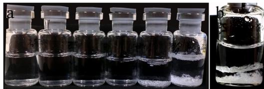
Abbildung 6.51.: Methylzellulose-Ibuprofen-Lösungen v.l.n.r. mit aufsteigender Ibuprofenkonzentration von 0,25, 1, 2, 4, 6 bis 8 Gew.-% Ibuprofen und 0,5 Gew.-% Methylzellulose im Puffer nach 4 Tagen bei Raumtemperatur (a). 13 Tage alte Lösung mit 8 Gew.-%igem Ibuprofen und 0,5 Gew.-% Methylzellulose in einer 1:1 Ethanol-Wasser Mischung (b).
