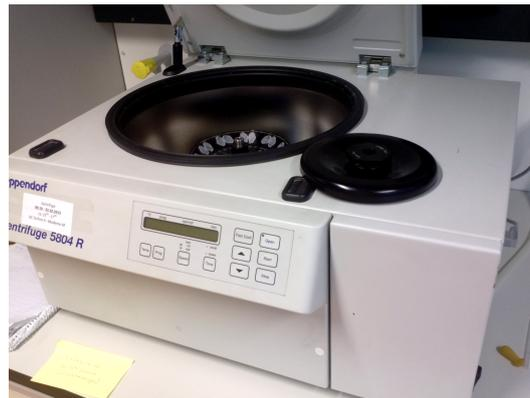
Abbildung 4.13.: Die für die Reinigung der Zelluloselösungen verwendete Zentrifuge 5804R von der Firma Eppendorf.
