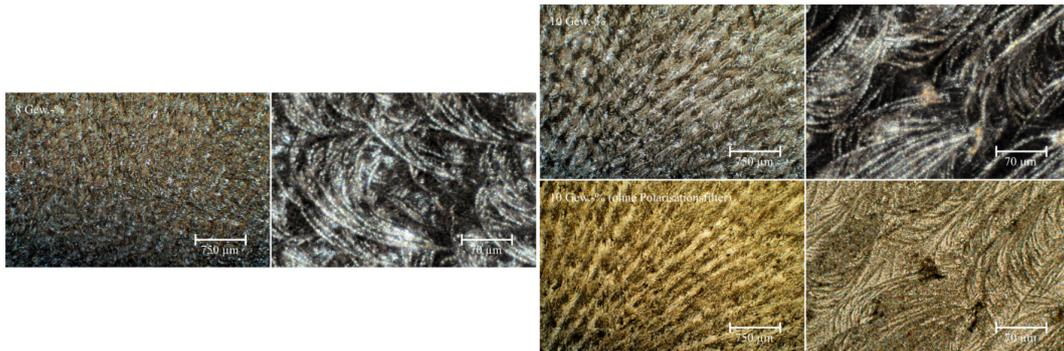
Abbildung 6.54.: Polarisationsmikroskopieaufnahmen von Spinlaminaten hergestellt aus einer Ibuprofen-Methylzellulose-Lösungen mit 8 (links) und 10 Gew.-%igem (rechts) Ibuprofen und jeweils 0,5 Gew.-%iger Methylzellulose. Der Abbildungsteil unten rechts zeigt Hellfeldaufnahmen von dem 10 Gew.-%igen Spinlaminat.
