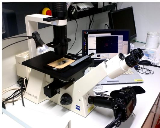
Abbildung 4.2.: Das erweiterte Durchlicht(-polarisations-)mikroskop Axiovert 40 CFL mit Kamera und Auswertelaptop.
