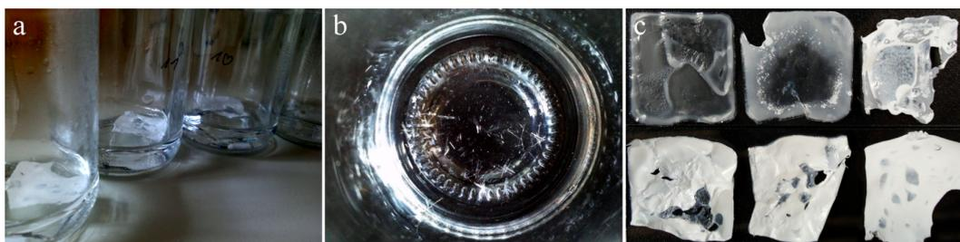
Abbildung 6.46.: Im Abbildungsteil a sind die vom Glassubstrat abgelösten Lamine während der Freisetzungstests dargestellt. Im Abbildungsteil b ist zum Teil auskristallisiertes Ibuprofen nach den Freisetzungstests gezeigt und im Abbildungsteil c die abgelösten Polystyrollamine nach dem Freisetzungstests von links nach rechts mit aufsteigender Konzentration: 2 Gew.-%, 4 Gew.-%, 6 Gew.-%, 8 Gew.-%, 10 Gew.-%, 20 Gew.-%.
