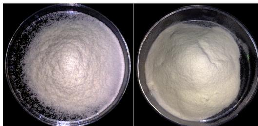
Abbildung 3.9.: Links die verwendete Methylzellulose in Pulverform und recht die zum Einsatz gekommene Hydroxyethylzellulose.
