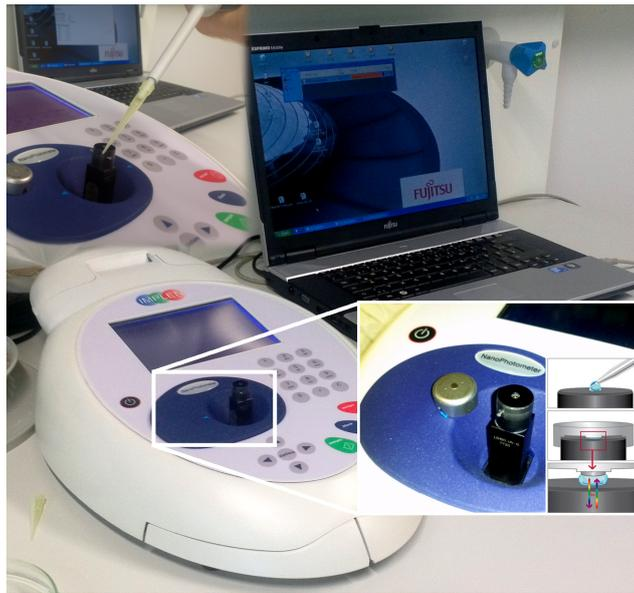
Abbildung 4.11.: Das *NanoPhotometer* von IMPLEN mit eingebauter *Microliter Cell*. In der Vergrößerung ist die Funktionsweise der *Microliter Cell* dargestellt [45].
