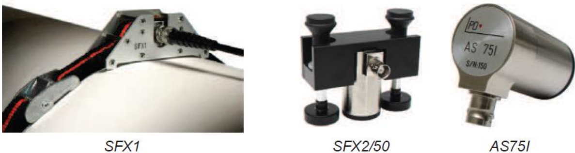
Abbildung 12: Akustische TE-Sensoren, Quelle: [19]
