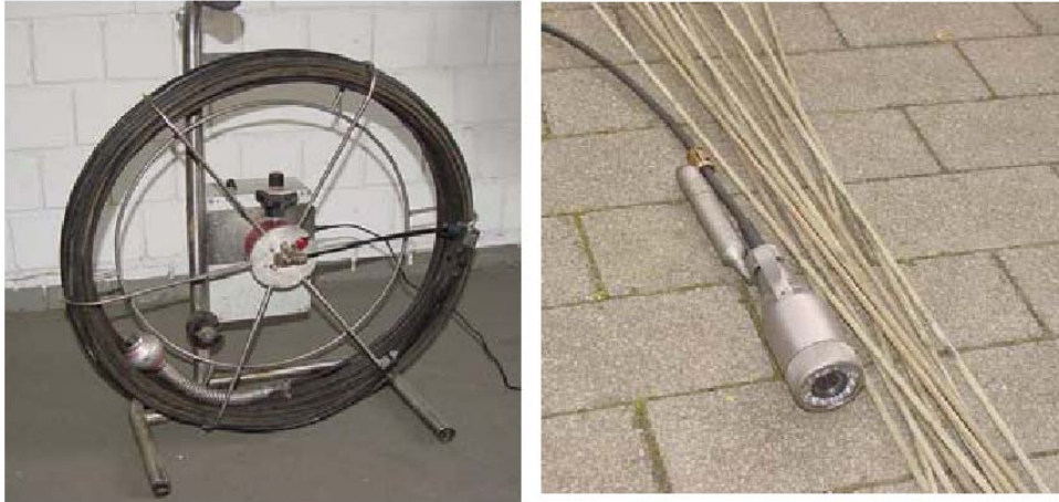
Abbildung 34: links: Glasfaserschubgestänge auf Haspel; rechts: Kamera mit Schiebestab (IKT, 2005)
