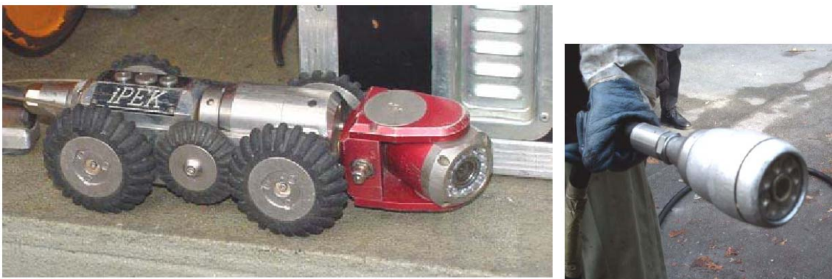
Abbildung 35: links: Fahrwagen mit Dreh-/Schwenkkopf; rechts: Spülkamera (IKT, 2005)
