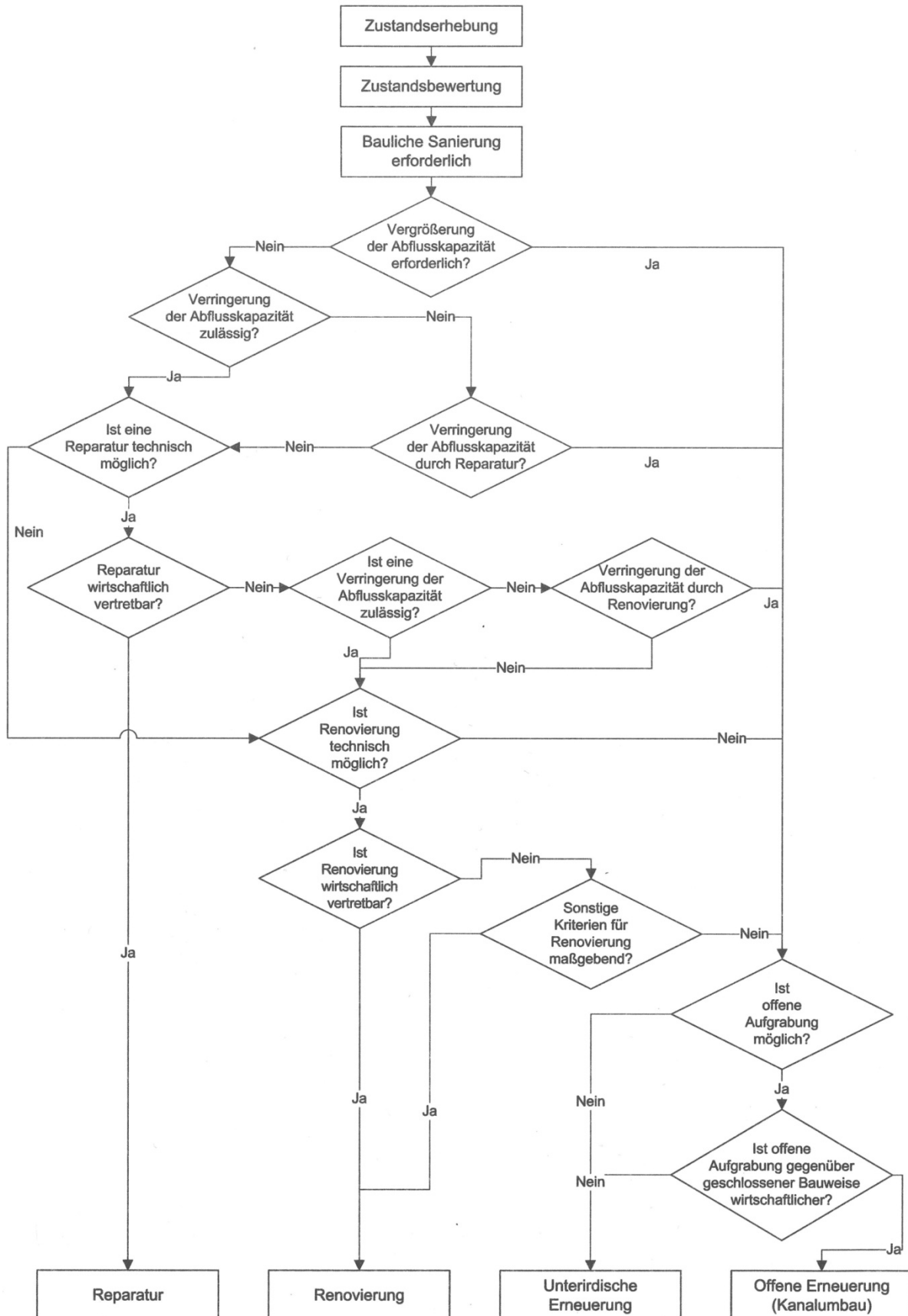
Abbildung 40: Ablaufdiagramm Kanalsanierung (ÖWAV-Regelblatt 28, 2007)
