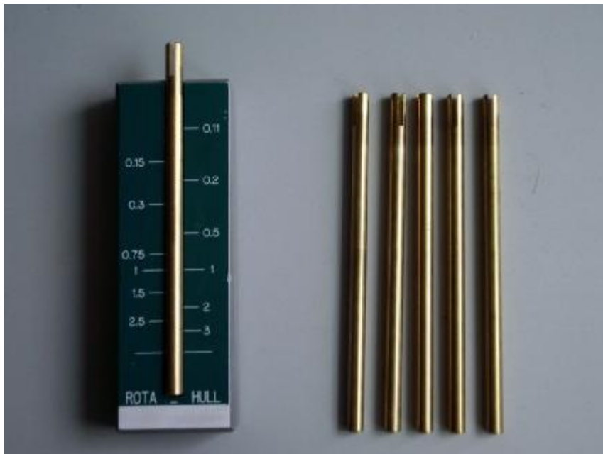
Abbildung 9: Zylinderelektroden sowie das dazugehörige Hullzellenlineal
