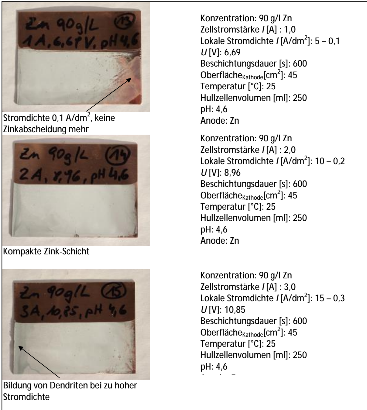
Abbildung 16: Zinkabscheidung mit zunehmenden Zellstromstärken
