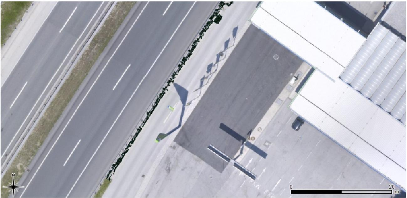
Abbildung 6.27: Ergebnis des Kantenextraktions Ansatzes einer Lärmschutzwand zu einem Rastplatz
