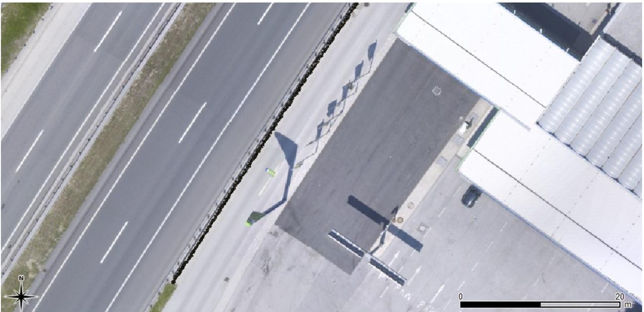
Abbildung 6.28: Ergebnis des Klassifizierungsansatzes einer Lärmschutzwand zu einem Rastplatz
