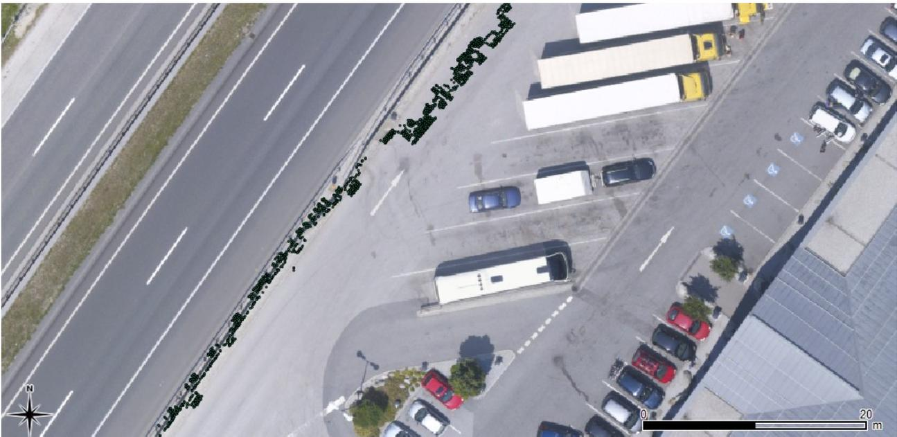
Abbildung 6.29: Ergebnis des Kantenextraktions Ansatzes einer Lärmschutzwand zu einem Rastplatz; fehlerhaftes Verhalten
