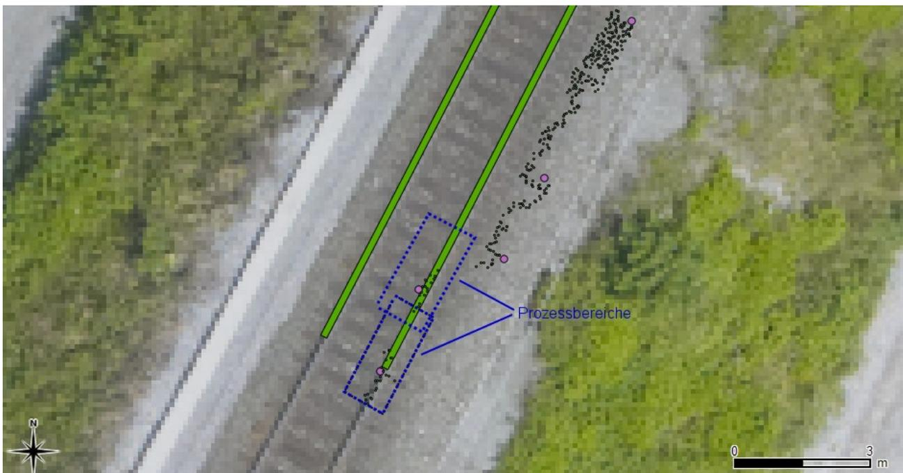
Abbildung 6.19: Ergebnis des ersten Ansatzes auf offener Strecke mit einem Luftbild hinterlegt; Grün: Die terrestrische Pufferzone mit 75 [mm]; Magenta: Boxzentren
