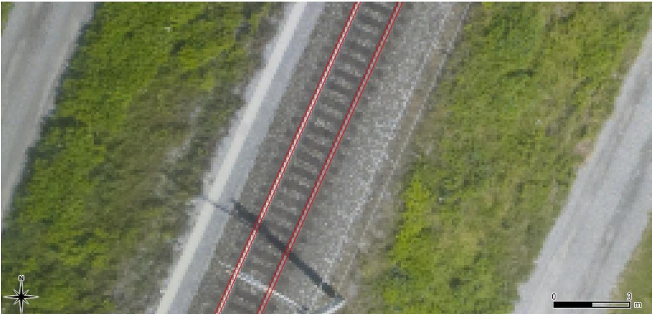
Abbildung 6.1: Aus den terrestrischen Daten abgeleitete parallele Linien (rot) stellen die umhüllende der Schienen dar
