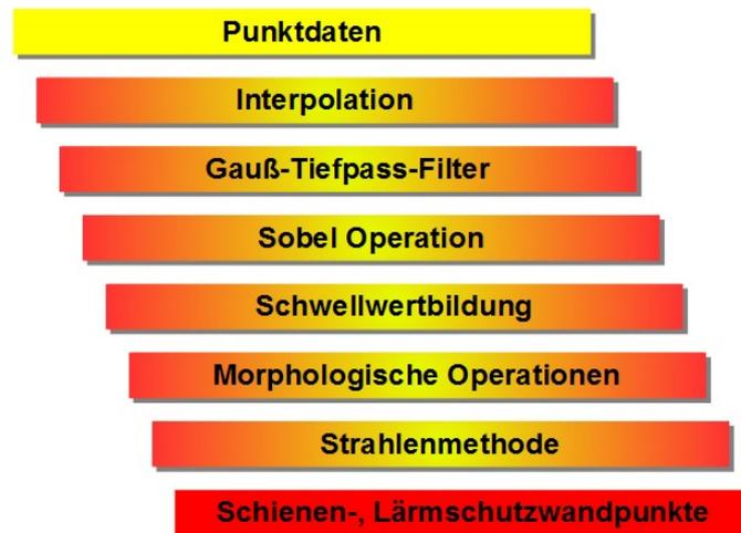
Abbildung 5.17: Ablauf der Kantenextraktion auf der Basis von Rasterdaten
