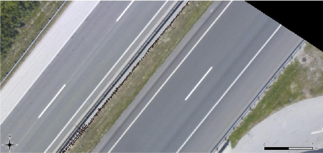
Abbildung 6.36: Ergebnis des Klassifizierungsansatzes einer Lärmschutzwand in der Mitte einer Autobahn; die größeren Punkte sind die Boxzentren; fehlerhaftes Verhalten
