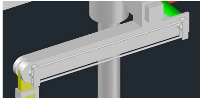
Abbildung 38: Kraftübertragung an den Hüftgelenken mittels Parallelogramm (Entwicklungsphase 3.1)
