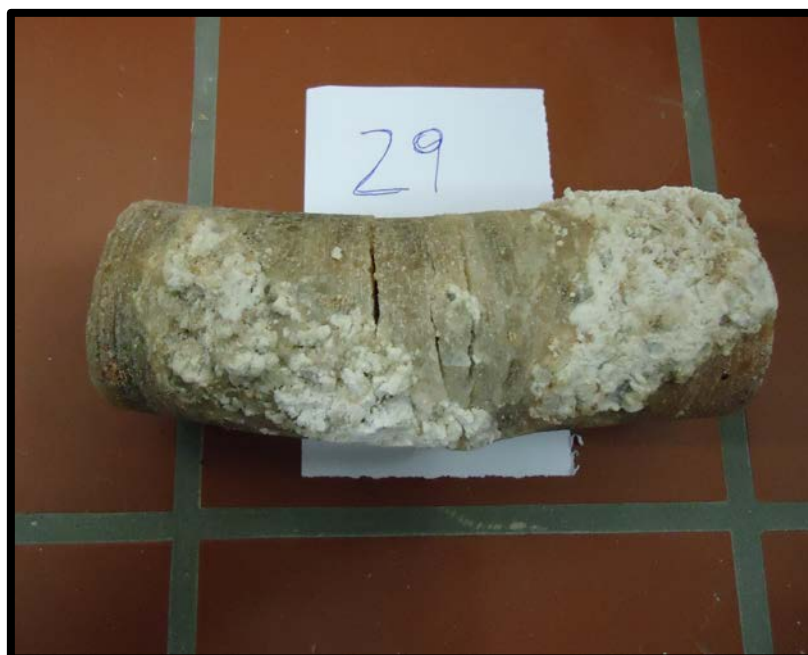
Abb. 45: Probe SI 29 Steinsalz mit sekundär an der Oberfläche "ausgeblühten" Sulfaten (weiß), die Länge des abgebildeten Bohrkernes beträgt ca. 15 cm.
