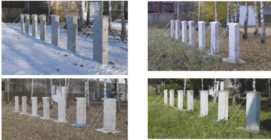
Abbildung 6.4 Außenlagerung der Wandprobekörper 157
