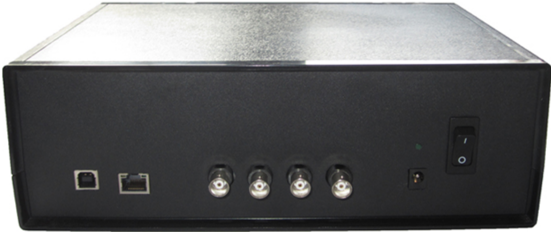
Abbildung 5.4: Die dem Probanden zugewandte Seite des Lock-in Verstärkers - die Gehäusefront
