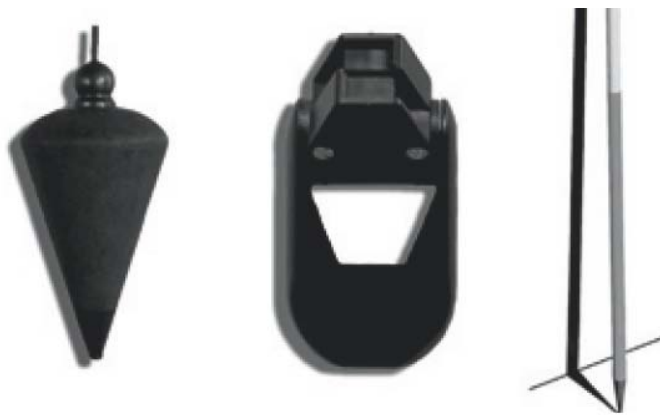
Abbildung 26 Lot, Doppelpentagon und Fluchtstab 230
