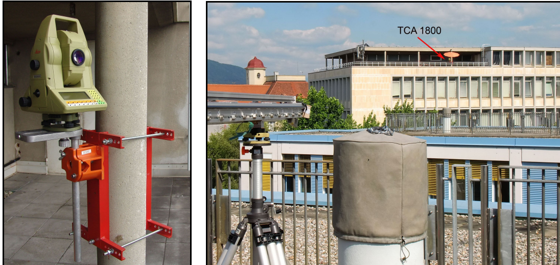
Abb. 11.3: Aufstellung des TCA 1800 mit Hilfe einer Konsole am Dach des Chemiegebäudes Stremayergasse 16 (links), Lage der Konsole am Dach des Chemiegebäudes (rechts).
