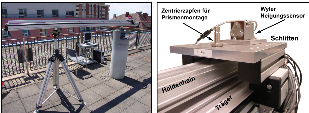
Abb. 6.1: Auf Industriestativ und Messpfeiler aufgebauter mobiler Feldkomparator (links) mit verschiebbarem Messschlitten (rechts).
