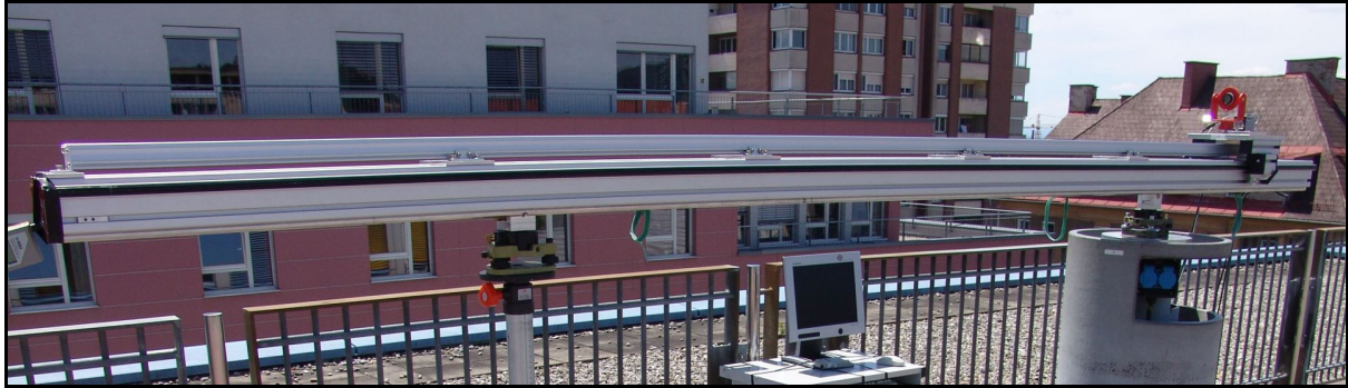
Abb. 9.5: Ziel am FC 2009, im Bild Miniprisma „Rot“ der Firma Geodäsie Austria.
