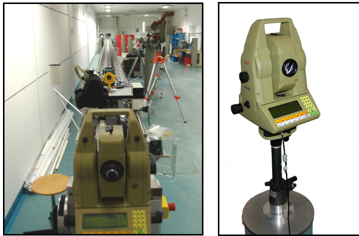
Abb. 8.2: 30 m lange Komparatorbank im Messlabor des Institutes für Ingenieurgeodäsie und Messsysteme (links), Leica TCA 1800 auf höhenverstellbarem Pfeiler (rechts).
