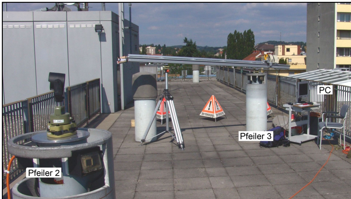
Abb. 11.2: Aufbau des mobilen Feldkomparators auf Pfeiler 3 und einem Industriestativ am Dach des Geodäsiegebäudes Steyrergasse 30.
