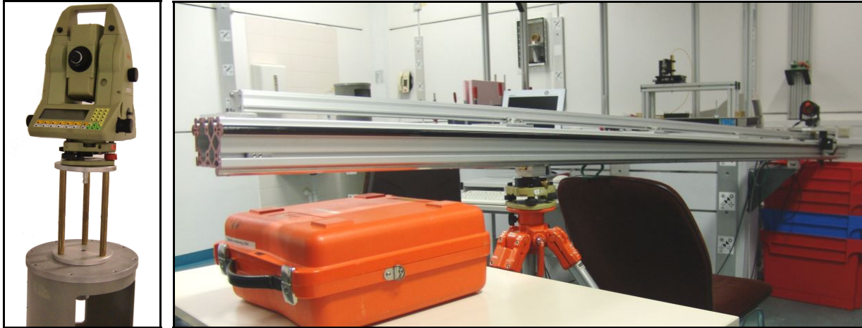
Abb. 10.8: Erhöhung des Instrumentenstandpunkts mit Hilfe eines Höhenadapters auf Pfeiler 3 (links); Aufbau der mobilen Testeinrichtung mit einer Schrägstellung um ca. 3° (rechts).
