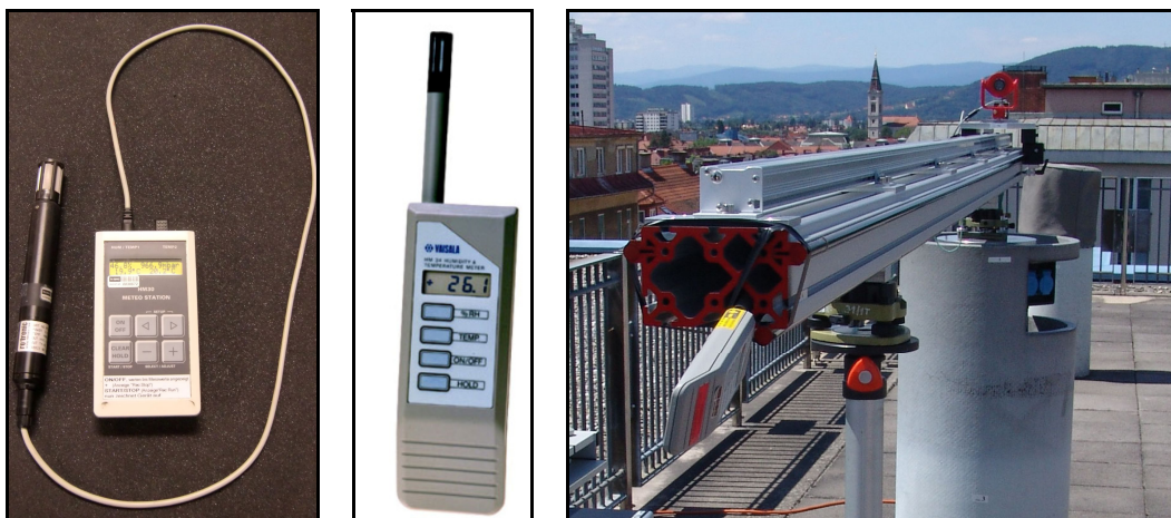
9.3: Thommen HM 30 (links); Vaisala HM 34 (Mitte); mobile Testeinrichtung mit HM 34 (rechts).
