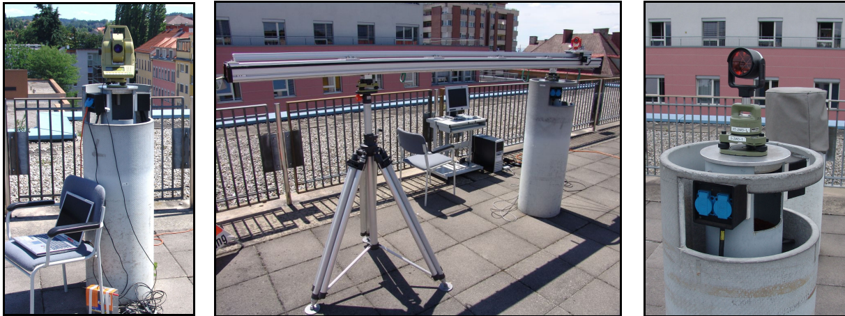
Abb. 9.2: Steuerung des TCA 1800 mit CALMS über einen Laptop (links); mobiler Feldkomparator auf Industriestativ und Messpfeiler mit Standcomputer (Mitte); Referenzziel auf betonierte Messpfeiler (rechts).
