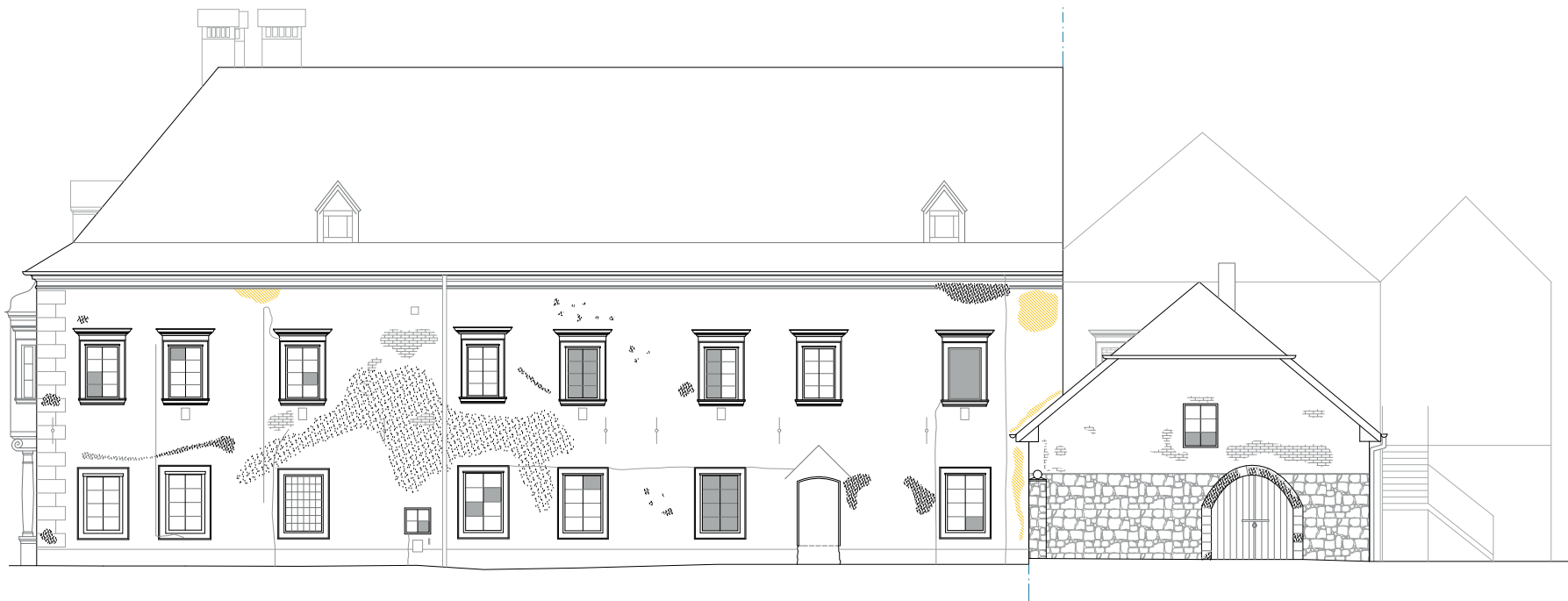
419 FASSADENANALYSE (M 1:200), ANSICHT NORDEN/OSTEN
