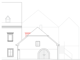
410 ZUGEMAUERTES FENSTER, FRÜHERE DACHFORM ANDERS!?
