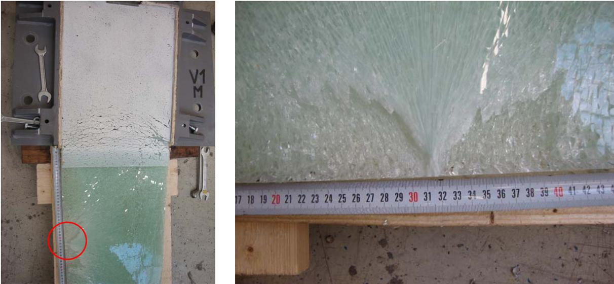
**Abb. 10.12** Bruchbilder des Versuchskörper V1M
