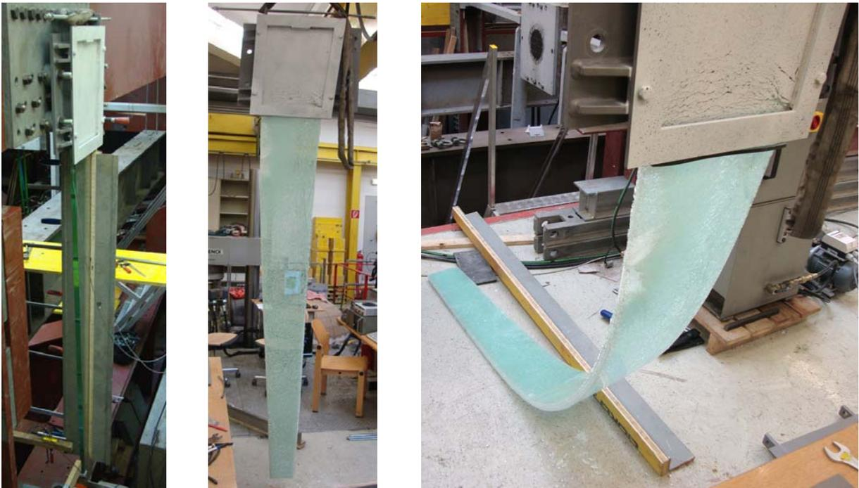
**Abb. 10.11** Links: Versuchskörper V1M während der Versuchsdurchführung; Mitte: Versuchskörper V1M nach dem Bruch - im Stahlschuh hängend; Rechts: Versuchskörper V1M nach dem Bruch - die Glaskrümmel haften an den PVB-Folien
