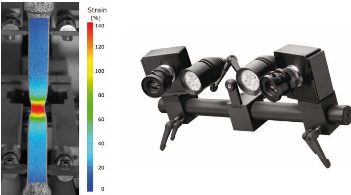
**Abb. 8.8** Links: Photogrammetrische Messung mit Aramis bei einem Zugversuch; Rechts: ARAMIS Messgerät (Kamera) [47]
