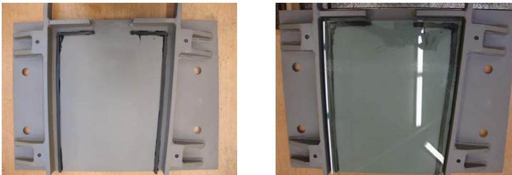
**Abb. 10.7** Links: Verkleben der Silikon-Dichtbänder als Abstandhalter;
