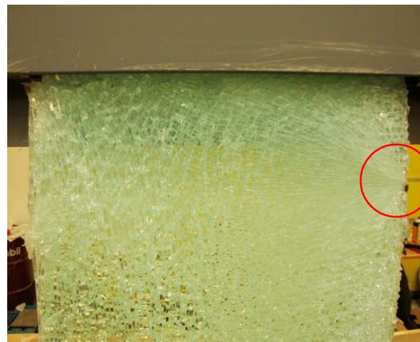
**Abb. 10.37** Bruchbilder des Versuchskörper R8M
