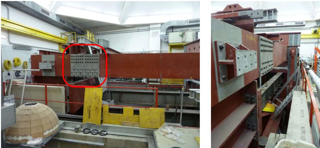
**Abb. 8.3** Prüfraumen mit Laschenstoss, an dem die Glasschwerter befestigt werden
