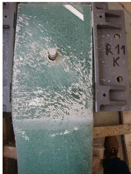
**Abb. 10.48** Bruchbilder des Versuchskörper R11K
