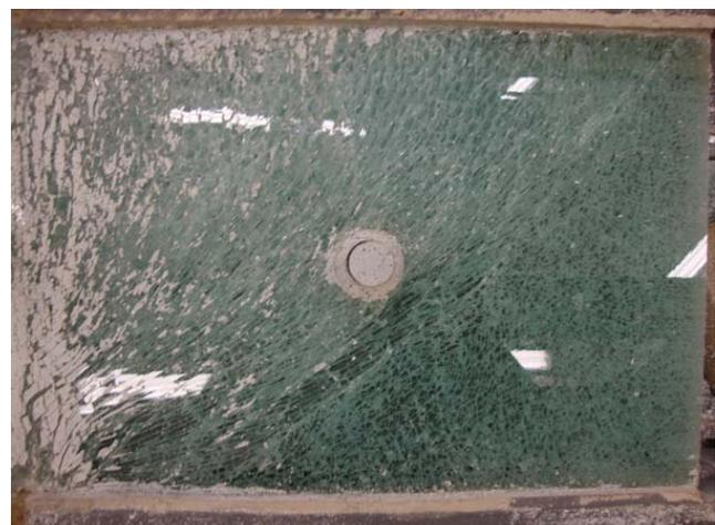
**Abb. 10.38** Bruchbilder des Versuchskörper R9M
