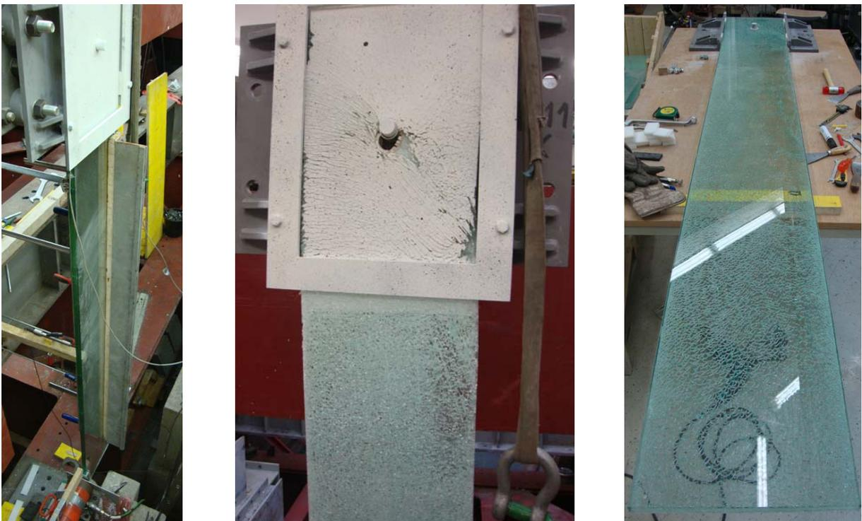
**Abb. 10.46** Links: Versuchskörper R10K während der Versuchsdurchführung; Mitte: Versuchskörper R11K nach dem Bruch - im Stahlschuh hängend; Rechts: Versuchskörper R12K nach dem Bruch - nur eine Scheibe ist gebrochen
