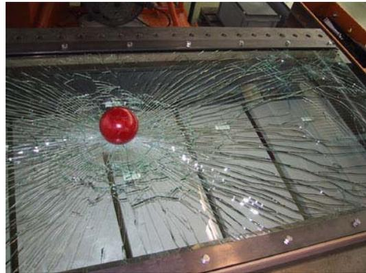
**Abb. 2.12** Links: VSG aus ESG mit Punkthalterung; Rechts: VSG aus TVG nach Kugelfallversuch [17]
