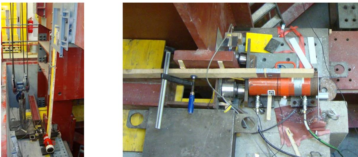
**Abb. 8.4** Links: Aufbau des Hydraulikzylinders; Rechts: Hydraulikzylinder
