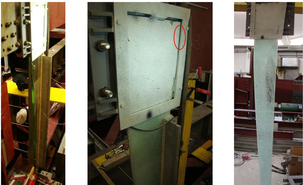
**Abb. 10.22** Links: Versuchskörper V5K während der Versuchsdurchführung; Mitte: Versuchskörper V4K nach dem Bruch - die Klotzung rechts oben ist nach unten verrutscht; Rechts: Versuchskörper V4K nach dem Bruch - im Stahlschuh hängend
