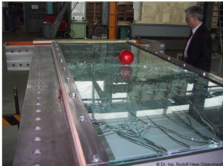
**Abb. 4.1** Links: Pendelschlagversuch [17]; Rechts: Kugelfallversuch [17]
