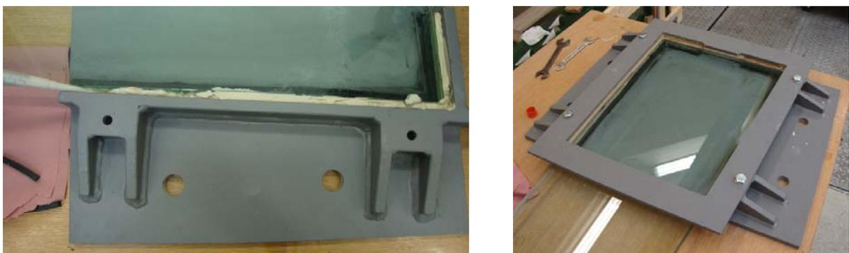
**Abb. 10.8** Links: Injizieren des Raumes zwischen Finne und Stirnblech mit Mörtel;
