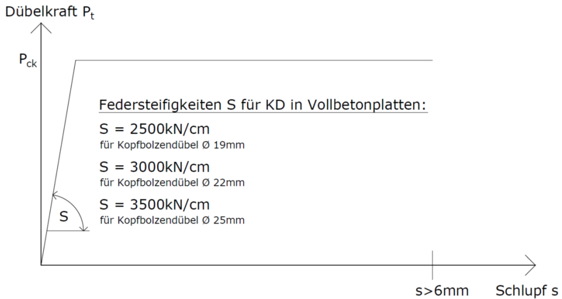
Abbildung 18: vereinfachte Dübelkennlinie für die Bemessung [8]
