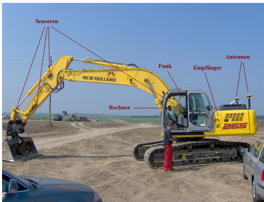
Abb. 6.8 Komponenten einer GPS Steuerung für Bagger 133
