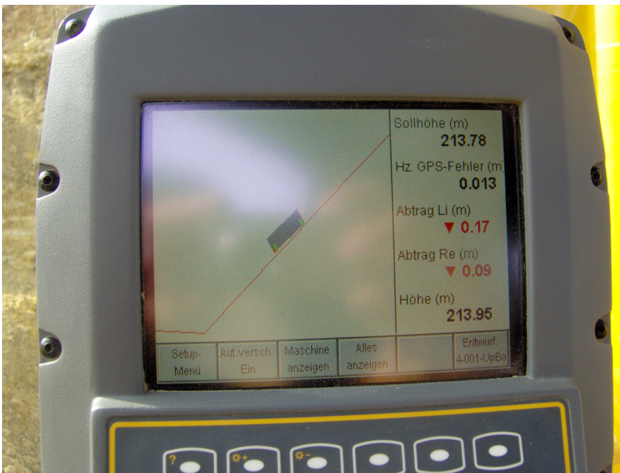
Abb. 6.11 Sicht aus Baggerkabine am Display 136
