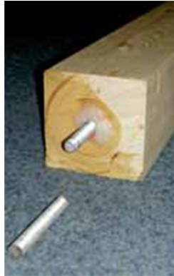
Abbildung 2-16: Ermüdungsbruch der eingeklebten Gewindestange, aus [22]
