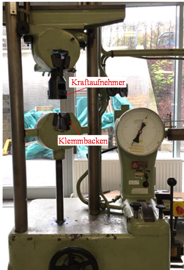
Abbildung 3-8: Hydraulikpulsator der TVFA
