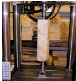
Abbildung 2-10: Prüfaufbau für die Ermüdungsversuche, aus [20]
