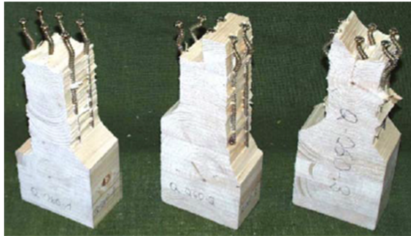
Abbildung 2-20: Ausknicken der Holzschrauben infolge Druckbeanspruchung, aus [30]
