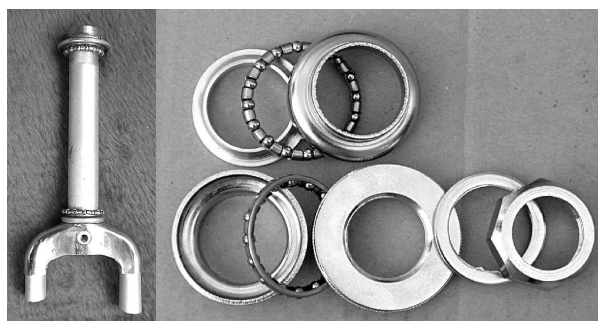
Abbildung 4.25: a) Lenkgabel; b) Lenkkopflager 1
