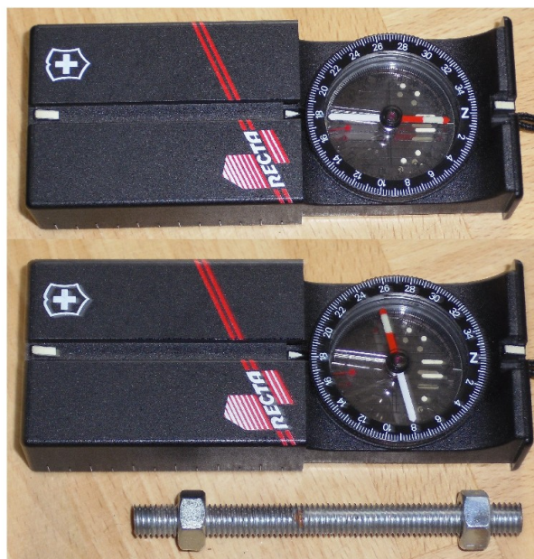
Abbildung 7.10: Missweisung durch einen Gewindebolzen
