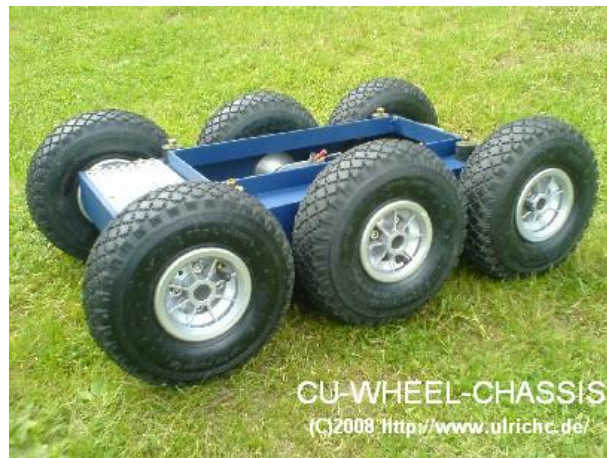
Abbildung 2.8: Radchassis nach UlrichC 6
