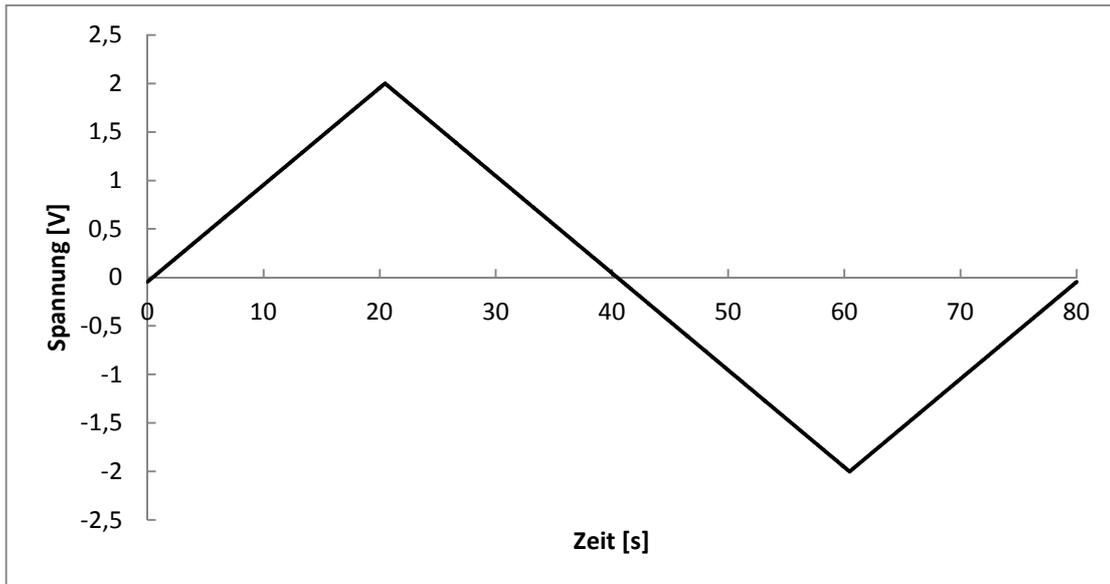
**Abbildung 10** Dreiecksförmiger Spannungsverlauf der angelegte Spannung, Beispielmessung für die Bestimmung des Oxidationspotentials
