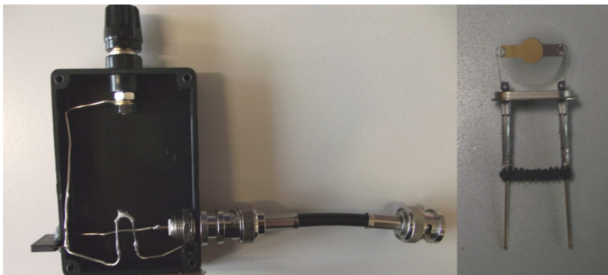
Abbildung 24: Verbindungsteil zwischen EQCM und Potentiostat/Galvanostat (links) und Schwingquarz mit Steckkontakten (rechts).
