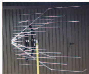
Bild 3: Logarithmisch periodische Antennen STLP 9128 D (links) und STLP 9149 (rechts)
