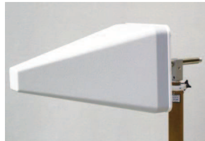
Bild 3: Logarithmisch periodische Antennen STLP 9128 D (links) und STLP 9149 (rechts)
