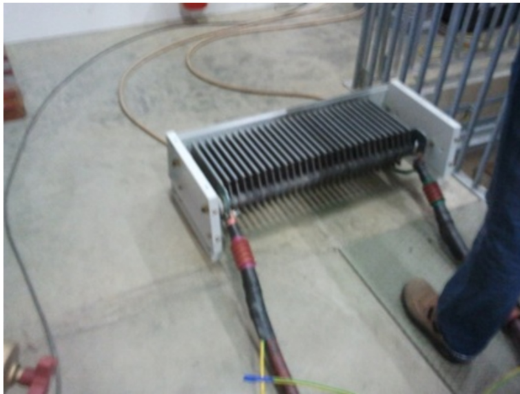
Abbildung 4.32.: Der in den Erregerkreis geschaltete Zusatzwiderstand ( R_{fd,zus} \cong 9,9 \Omega ).
