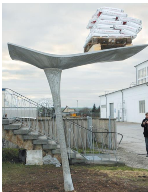
Abbildung 10 – Belastungstest des Parapulie [9]
