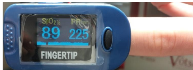
Abbildung 4.19 Anzeige des Geräts MD300C2 während eines Störversuchs
