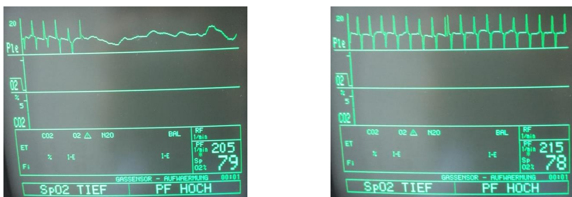
Abbildung 4.17 Anzeige veränderter Kurvenformen und falscher Werte am Gerät Capnomac
