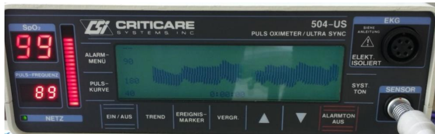
Abbildung 4.14 Anzeige der verzerrten Pulskurve des Geräts 504-US bei einem Störversuch
