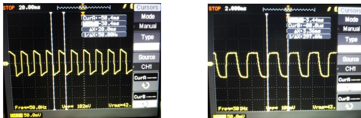
Abbildung 4.9 Oszillogramme des LED-Feldes im Betrieb bei 50Hz &amp; 300Hz
