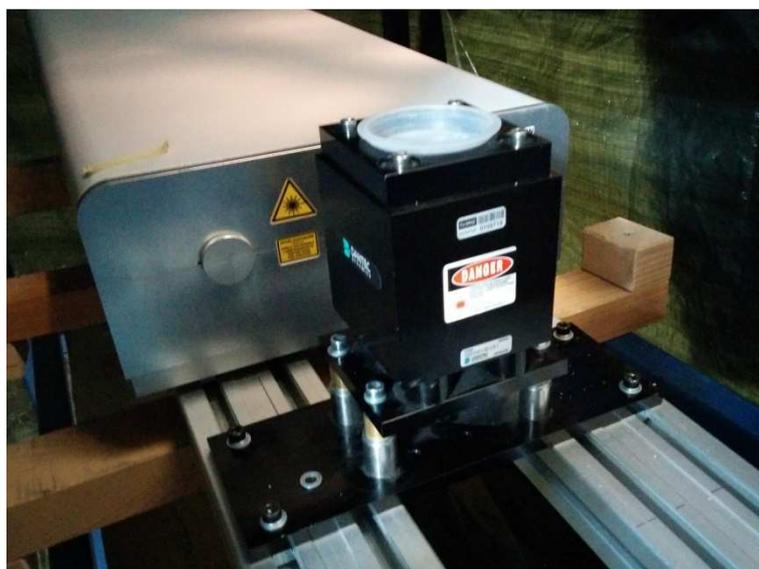
**Abbildung 42: Base mit oberer Deckplatte**
