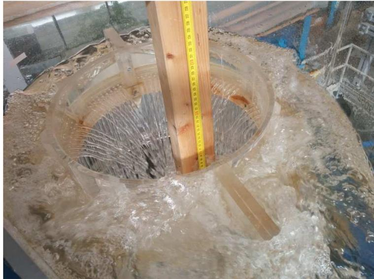
Abbildung 46: Befüllen des Schachtes für Kalibriervorgang mit Messlatte
