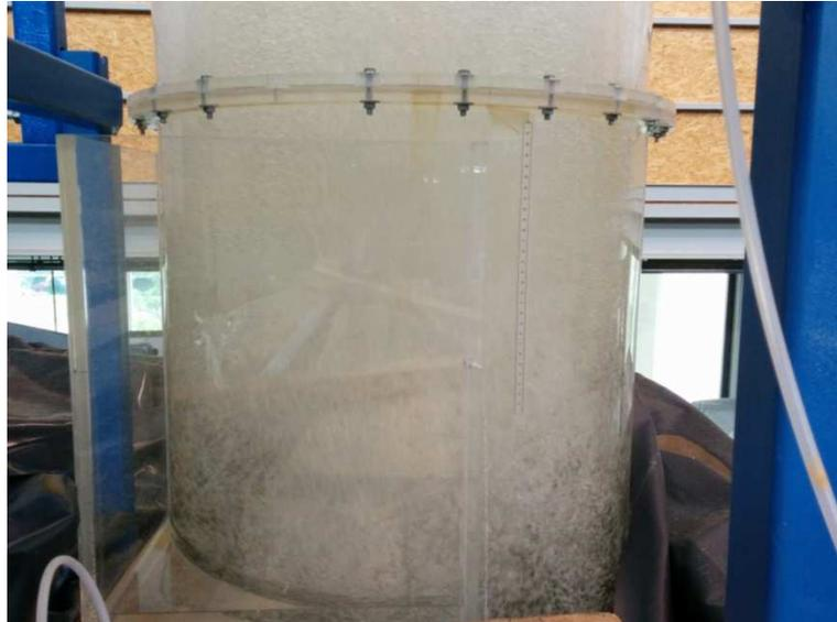
Abbildung 94: oberer Luftblasenpolster bei 16 l/s und WSP 2043 müA
