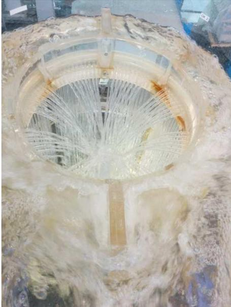
**Abbildung 115: horizontal- und vertikale Aufteilung des Oberkammerschwalls**
