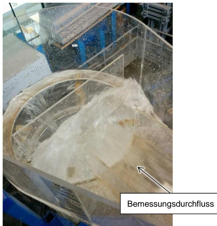
**Abbildung 93: Wasserfall bei Bemessungsdurchfluss**
