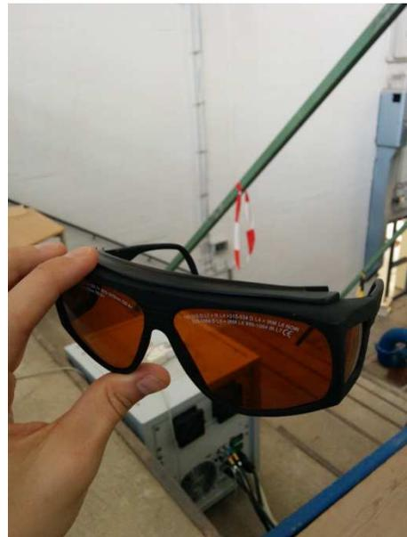
**Abbildung 114: Laserschutzbrille**
