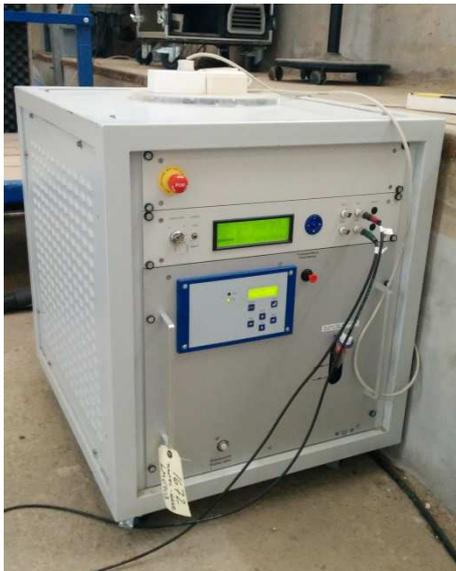
**Abbildung 113: Laser - Kühlaggregat**
