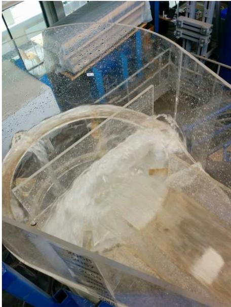
**Abbildung 119: Bemessungsdurchfluss ohne Dämpfungselement in der Oberkammer**
