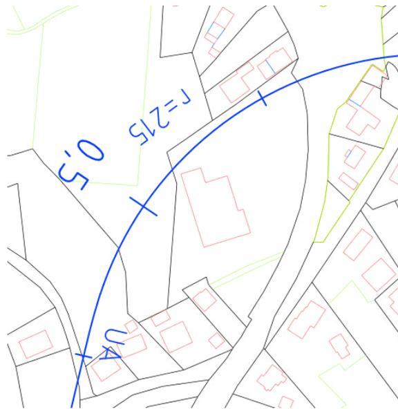
Abbildung 9: Beispielhafte Trassierung im dicht verbauten Gebiet
