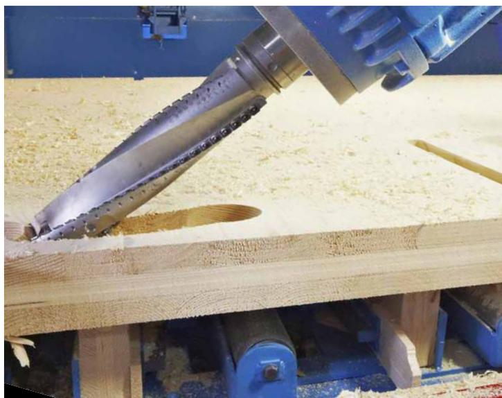
Abb. 2.3 Fräsung in einer Massivholzplatte, [16]
