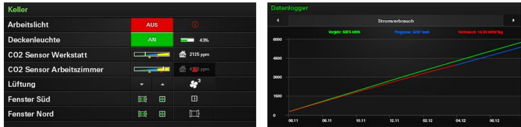
Abb. 9.3 Beispiel einer Steuerungsmöglichkeit und Datenlogger am Steuerungs-Touchpad „Gira Control 9 KNX“ [126]
