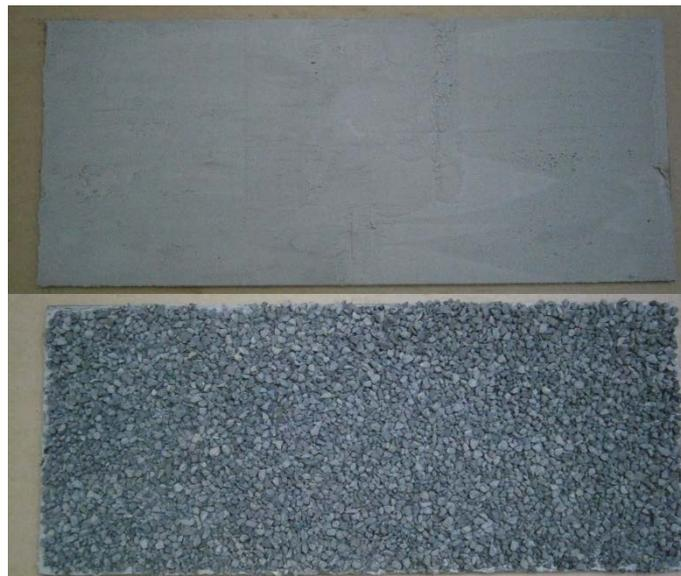
**Abbildung 4.32:** Stahlplatte mit Epoxidharzbeschichtung (oben) und mit Basaltspliteinstreuung (unten)
