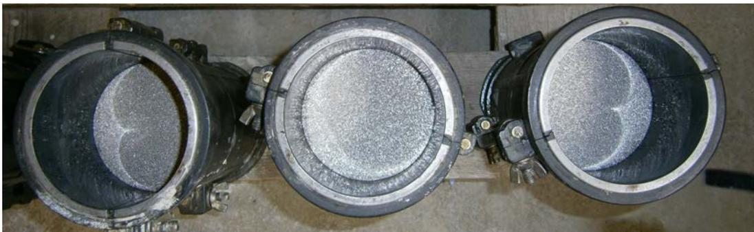
**Abbildung 4.6:** Stahlstempel in den Zylinderschalungen
