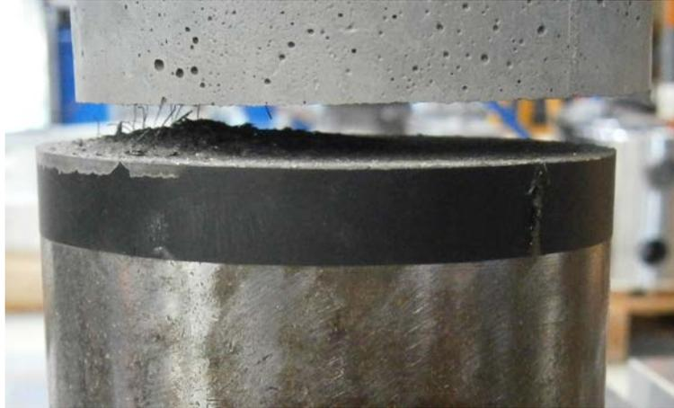
**Abbildung 4.29:** Versatz zwischen unterem und oberem Probekörperteil
