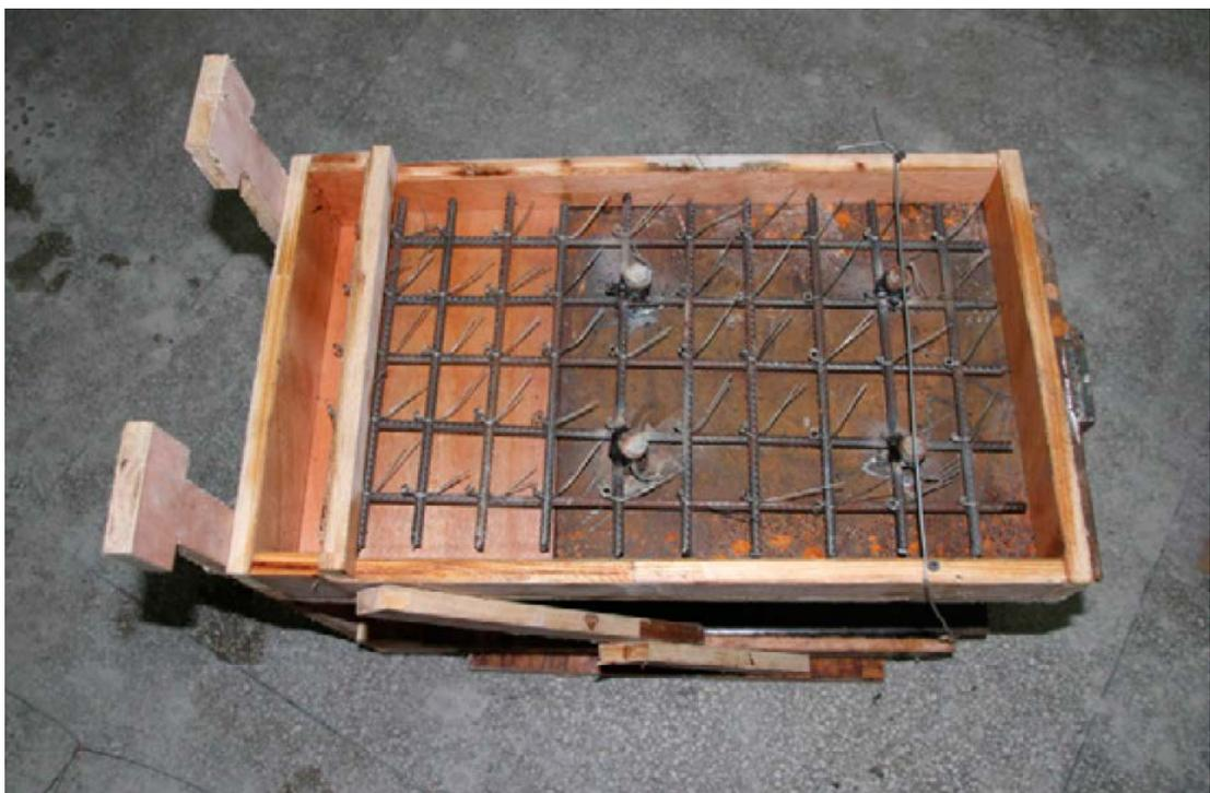
**Abbildung 2.17:** Versuchskörper vor dem Betonieren [14]
