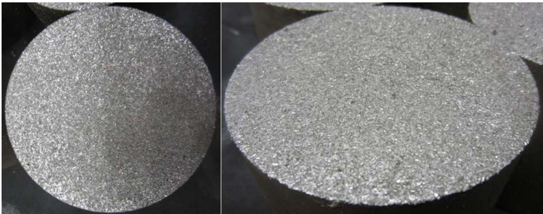
**Abbildung 4.5:** Sandgestrahlte Oberfläche
