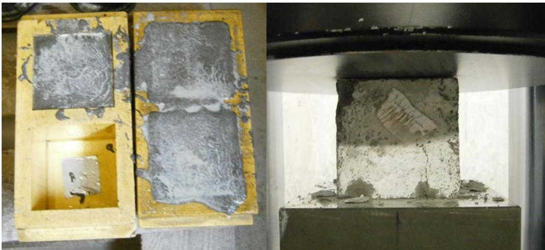
**Abbildung 4.18:** Prüfwürfel in der Schalung (links), Druckprüfung (rechts)
