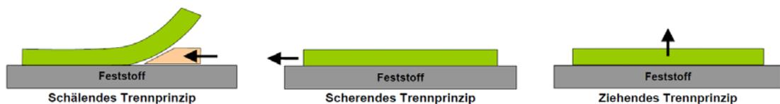
**Abbildung 4.1:** Trennprinzipien zur Bestimmung der Adhäsionskraft [10]
