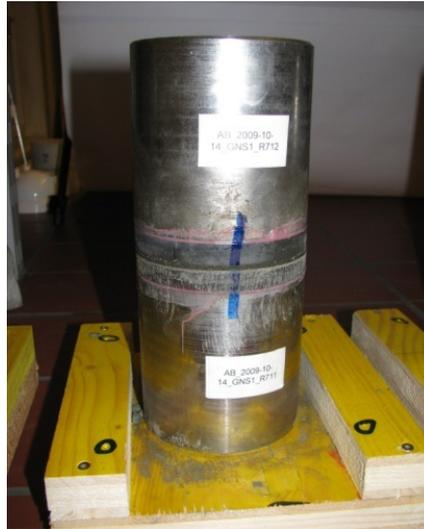
**Abbildung 3.10:** Fertiger Probekörper ohne Verdunstungsschutz [10]
