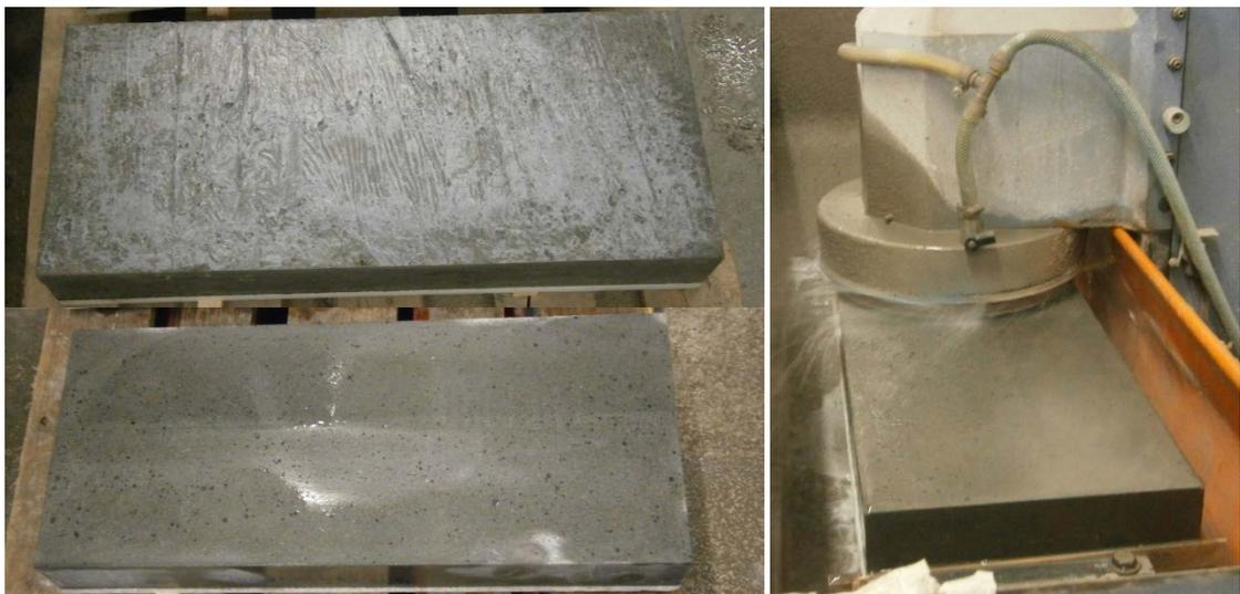
**Abbildung 4.35:** Probekörper mit "Elefantenhaut" (links oben), während des Schleifens (rechts) und nach dem Schleifen (links unten)
