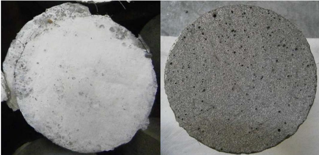
Abbildung 4.10: Unbehandelte (links) und geschliffene (rechts) Oberfläche (UHPC mit Stahlfasern)
