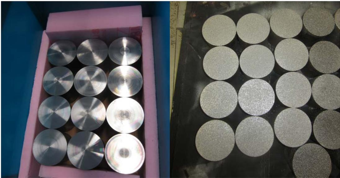
**Abbildung 4.4:** Plangefräste (links) und sandgestrahlte (rechts) Stahlzylinder
