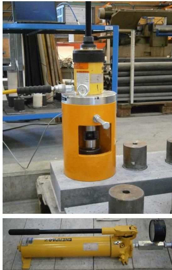
**Abbildung 4.39:** Hohlkolbenzylinder (oben) und Hydraulikpumpe (unten)
