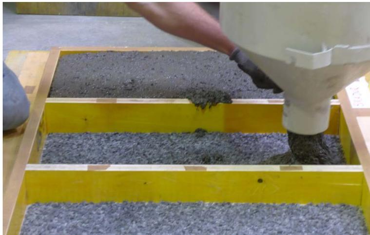
**Abbildung 4.34:** Einbringen des UHPC
