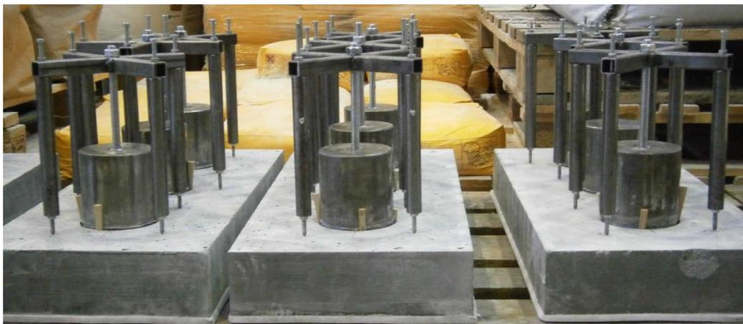
**Abbildung 4.38:** Aufkleben der Stahlzylinder für die Haftzugprüfung mit Abstandhalter
