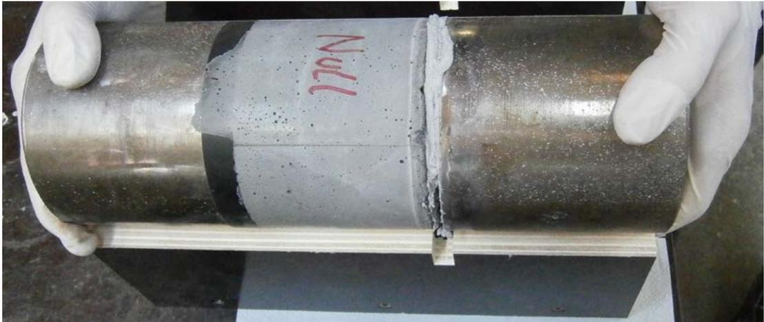
**Abbildung 4.13:** Anbringen des 2. Stahlzylinders
