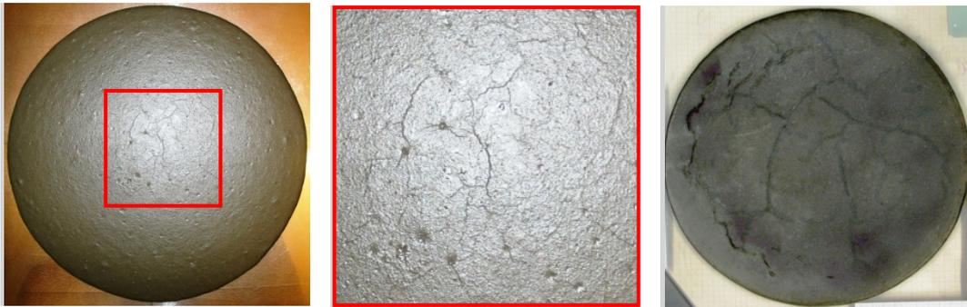
**Abbildung 3.6:** Ausbreitkuchen 1h nach Betonherstellung (links), Risse im Zentrum des Kuchens (mitte), Unterseite des Ausbreitkuchens nach 4 Wochen [10]
