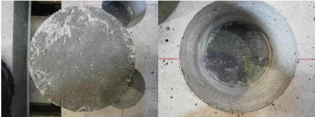
Abbildung 4.44: Bruchfläche sandgestrahlter Stahl 2
