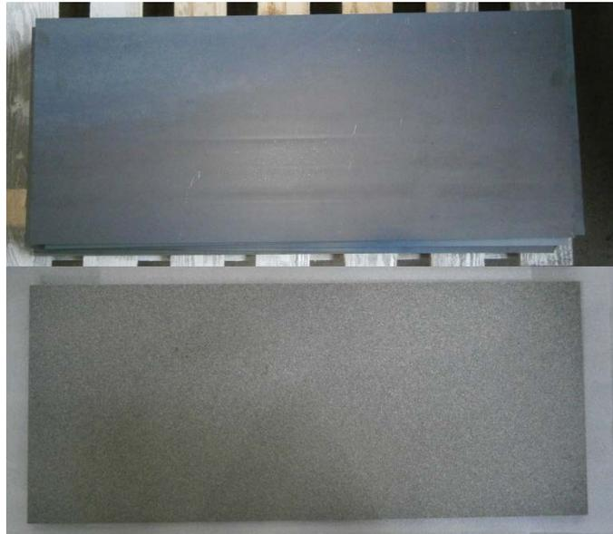
**Abbildung 4.31:** Stahlplatten vor (oben) und nach (unten) dem Sandstrahlen
