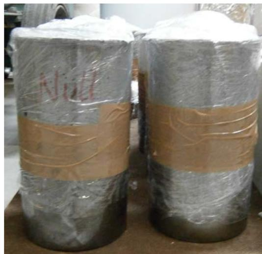
**Abbildung 4.9:** Verbundprobekörper mit Verdunstungsschutz
