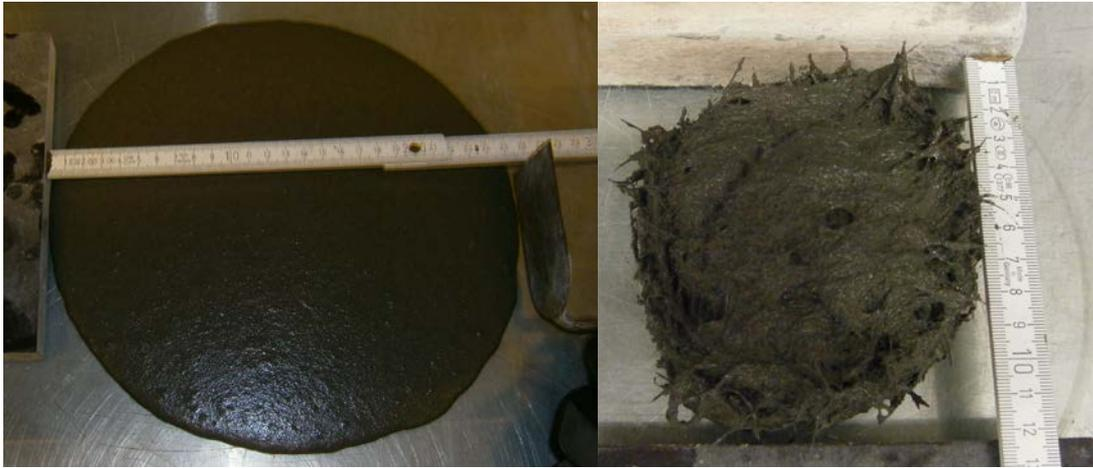
**Abbildung 4.17:** Setzmaß UHPC ohne Fasern (links), UHPC mit Basaltfasern (rechts)
