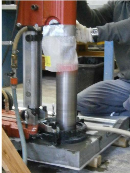
**Abbildung 4.36:** Bohren der Zylinder
