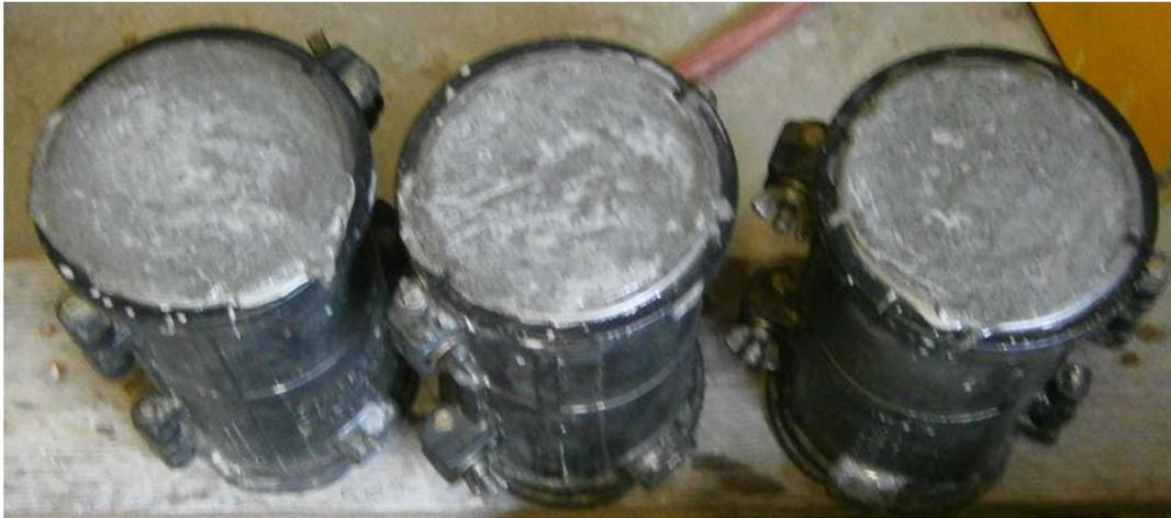
**Abbildung 4.7:** Mit Beton (UHPC ohne Fasern) befüllte Zylinderschalungen
