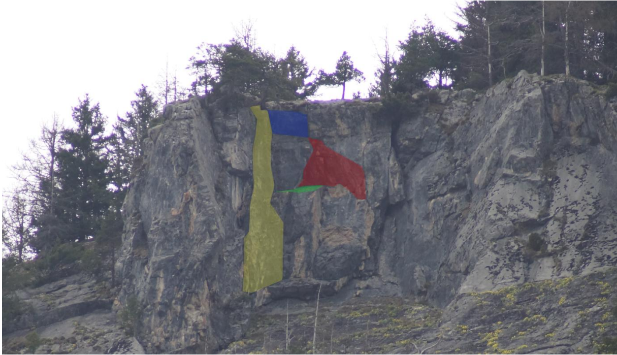
Abbildung 82: Darstellung des Blockes "101000" anhand eines Fotos. Die Trennflächen sind farblich markiert.
