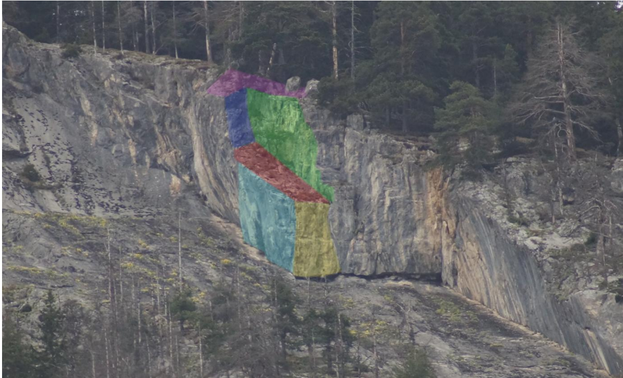
Abbildung 62: Darstellung des Blockes "001001" anhand eines Fotos. Die Trennflächen sind farblich markiert.
