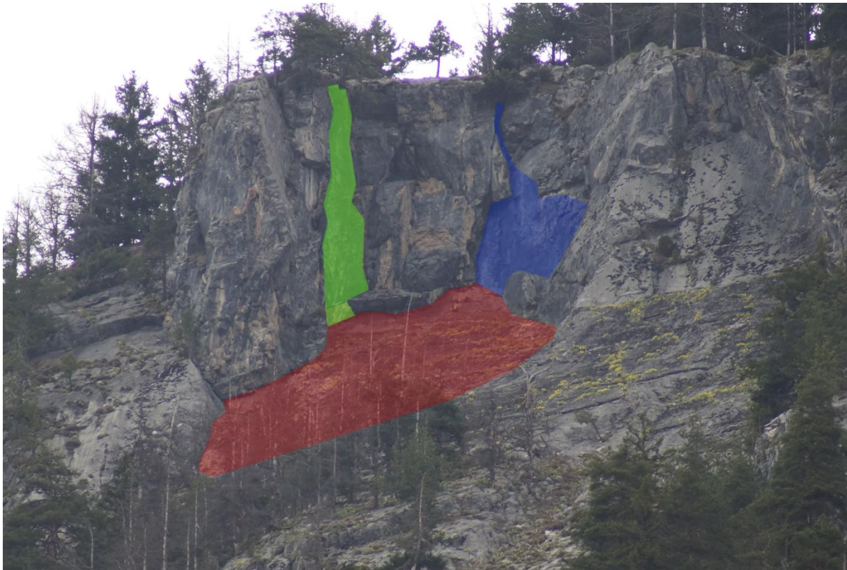
Abbildung 87: Darstellung des Blockes "000011" anhand eines Fotos. Die Trennflächen sind farblich markiert.
