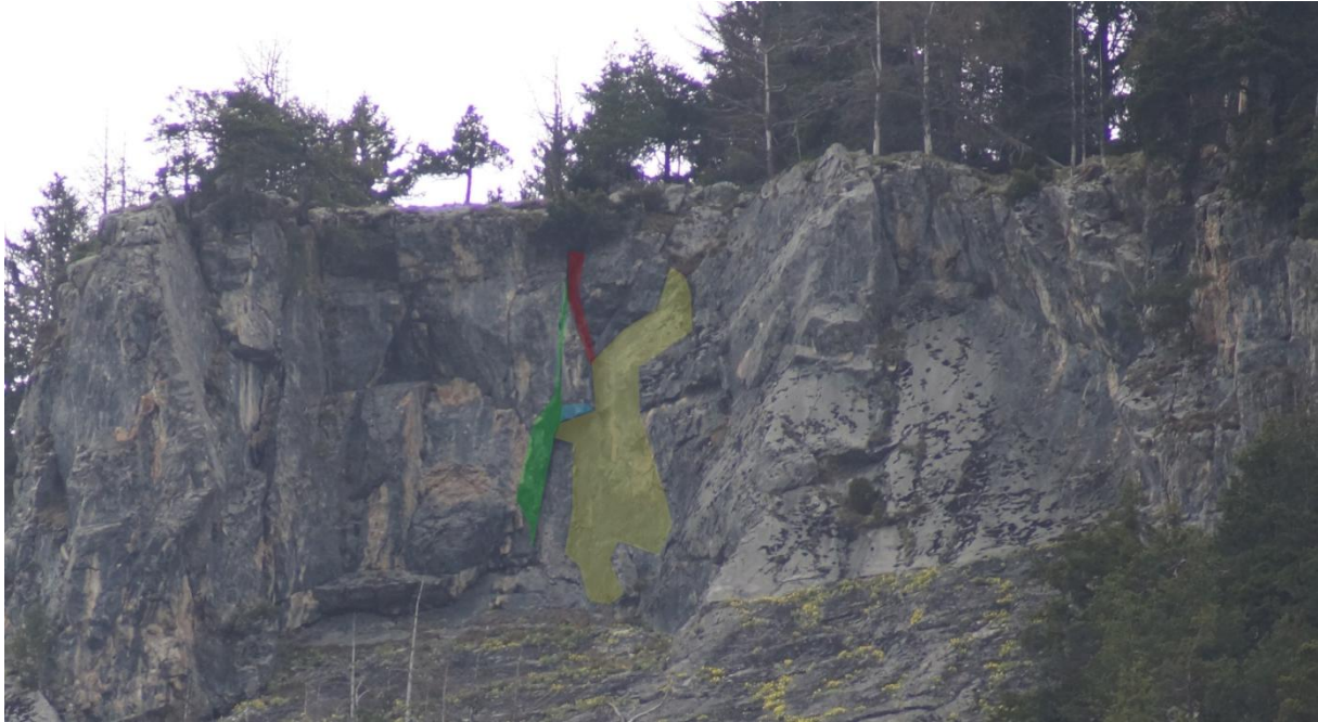
Abbildung 77: Darstellung des Blockes "010100" anhand eines Fotos. Die Trennflächen sind farblich markiert.
