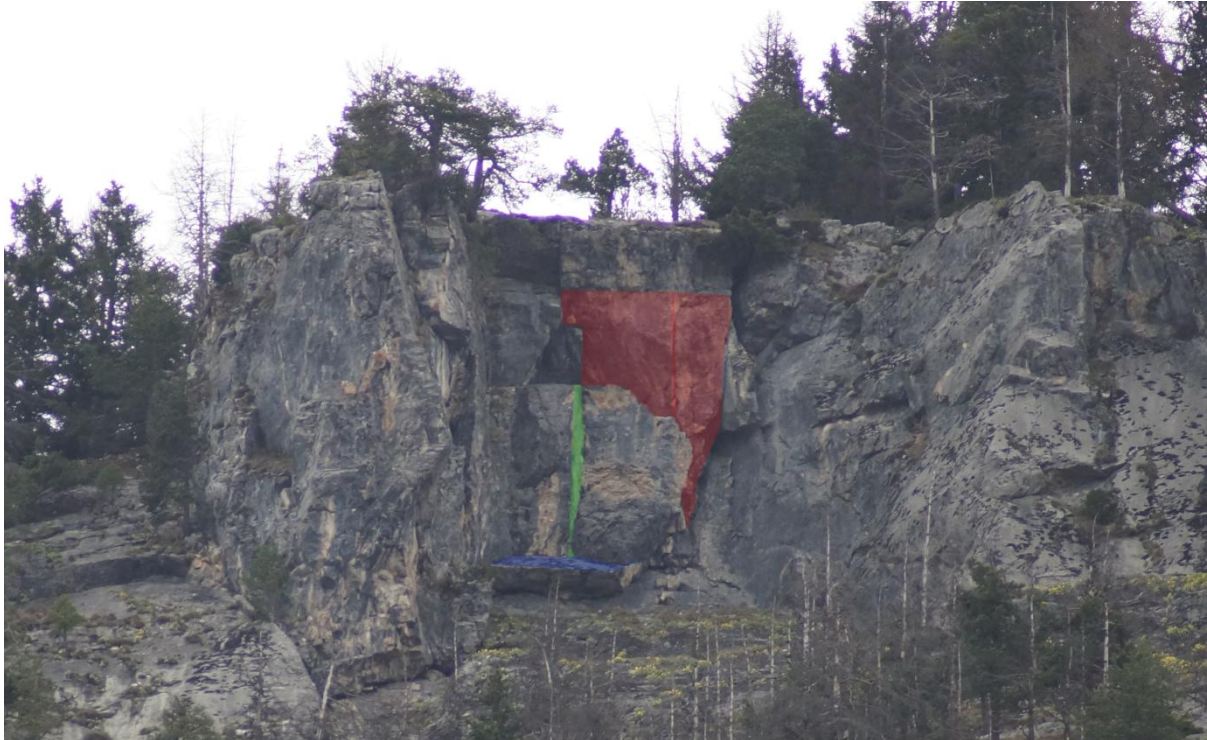
Abbildung 72: Darstellung des Blockes "100n1" anhand eines Fotos. Die Trennflächen sind farblich markiert.
