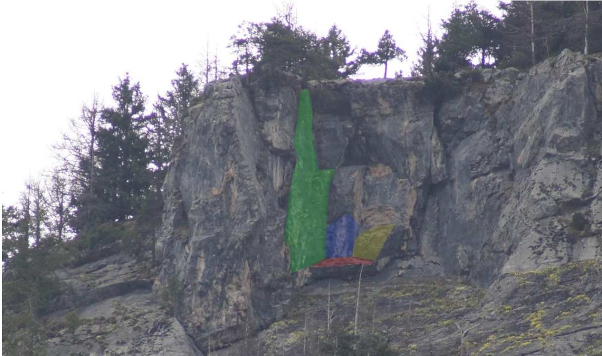
Abbildung 52: Darstellung des Blockes "0110010" anhand eines Fotos. Die Trennflächen sind farblich markiert.
