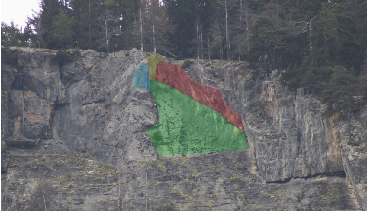
Abbildung 57: Darstellung des Blockes "1010010" anhand eines Fotos. Die Trennflächen sind farblich markiert.
