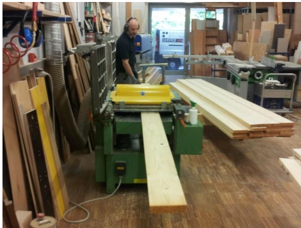
Abbildung 5-24: Hobeln der Lamellen für die Prüfkörper: links: Hobelvorgang; rechts: fertig gehobelte Lamellen
