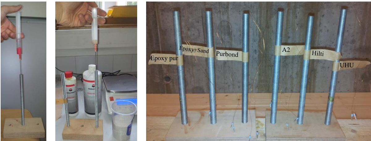
Abbildung 4-20: Kriechversuche verschiedener Klebstoffe; Herstellung: links: Einfüllen des Hilti-Klebstoffs [85]; Mitte: Einfüllend des Toolcraft-Klebstoffs [84], vermischt mit feinem Quarzsand; rechts: fertige Versuchskörper
