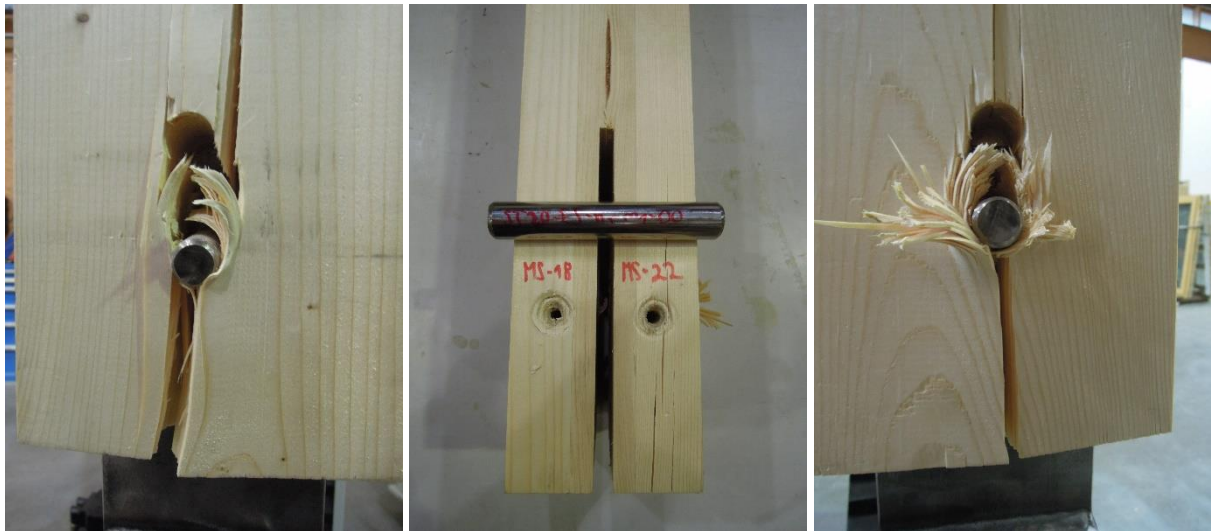
Abbildung ANHANG 41: Bruchbilder ST20-ES-n1-m1-00: links: Seite MS16; rechts: Seite MS19
