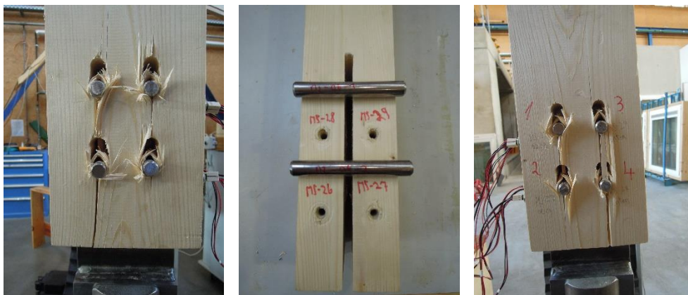
Abbildung ANHANG 102: Bruchbilder ST16-ES-n2-m2-06: links: Seite MS26; rechts: Seite MS27
