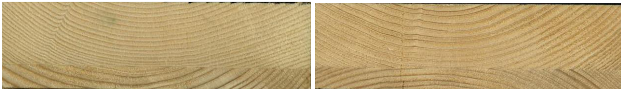
Abbildung 6-26: Jahrring-Scan der Prüfung ST16-ES-n2-m2-02: links: Seite MS-26; rechts: Seite MS-27
