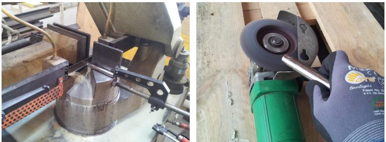
Abbildung 5-33: Bearbeiten der Edelstahl-Stabdübel: links: Ablängen; rechts: Anbringen einer Fase
