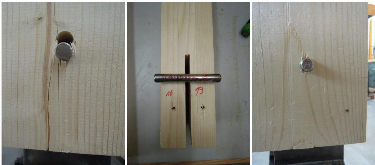
Abbildung ANHANG 37: Bruchbilder ST16-ES-n1-m1-05: links: Seite MS16; rechts: Seite MS19
