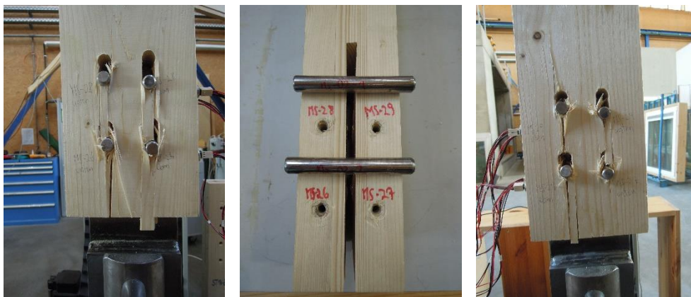
Abbildung ANHANG 87: Bruchbilder ST16-ES-n2-m2-02: links: Seite MS26; rechts: Seite MS27
