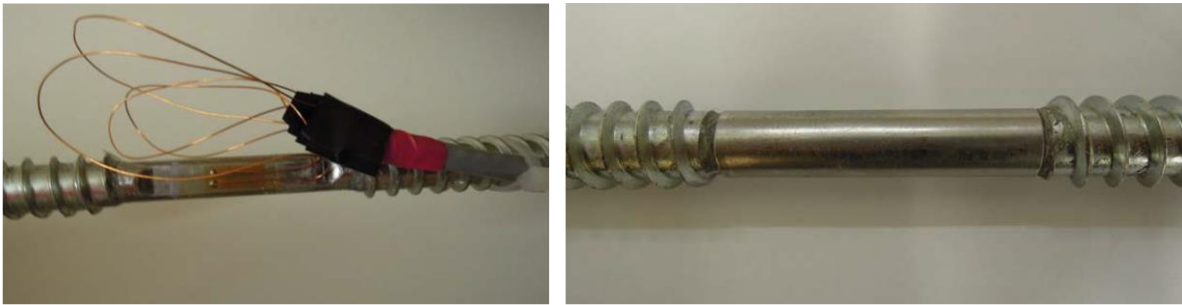
Abbildung 2-19: Messstelle auf Schraubstange [45]: links: applizierter DMS mit Anschlusskabel; rechts: Schutzhülse
