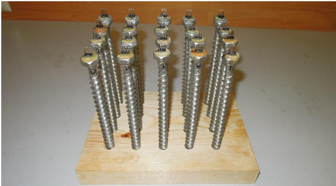
Abbildung 5-42: fertig hergestellte Messschrauben
