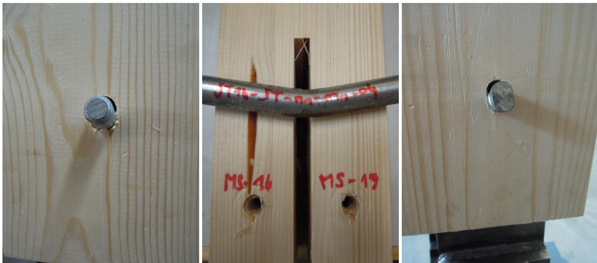
Abbildung ANHANG 15: Bruchbilder ST16-ST-n1-m1-04: links: Seite MS16; rechts: Seite MS19
