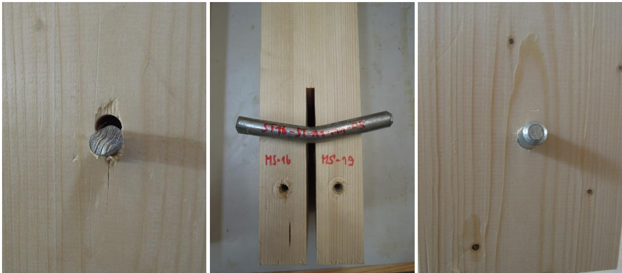
Abbildung ANHANG 18: Bruchbilder ST16-ST-n1-m1-05: links: Seite MS16; rechts: Seite MS19
