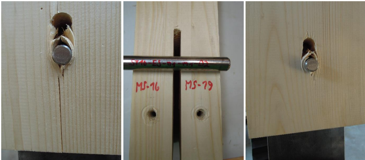
Abbildung ANHANG 28: Bruchbilder ST16-ES-n1-m1-02: links: Seite MS16; rechts: Seite MS19
