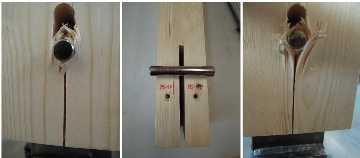
Abbildung ANHANG 47: Bruchbilder ST20-ES-n1-m1-02: links: Seite MS16; rechts: Seite MS19
