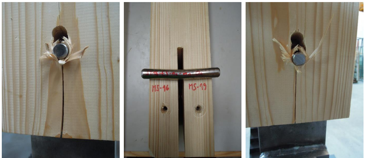
Abbildung 6-6: Bruchbilder der Prüfung ST16-ES-n1-m1-04: links: Seite MS-16; rechts: Seite MS-19
