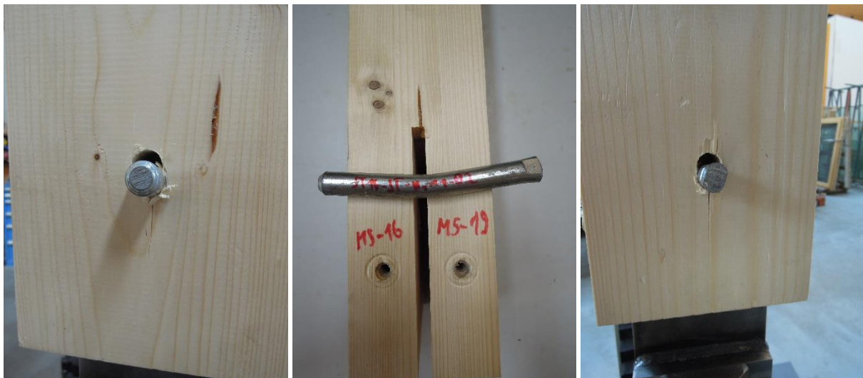
Abbildung ANHANG 9: Bruchbilder ST16-ST-n1-m1-02: links: Seite MS16; rechts: Seite MS19
