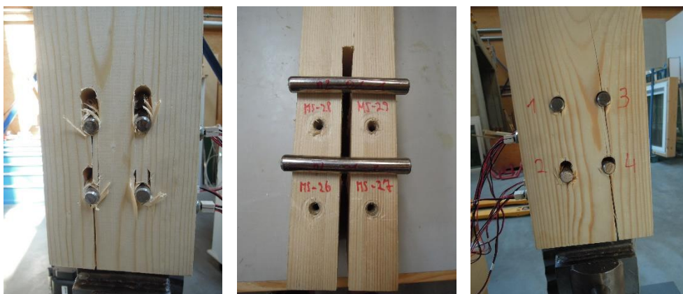
Abbildung ANHANG 83: Bruchbilder ST16-ES-n2-m2-01: links: Seite MS26; rechts: Seite MS27
