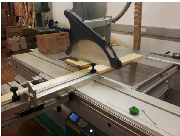
Abbildung 5-25: Formatieren der Prüfkörperlamellen: links: Ablängen der Lamellen auf der Tischkreissäge und Zusammenstellen der BSH-Prüfkörper
