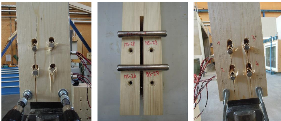
Abbildung ANHANG 91: Bruchbilder ST16-ES-n2-m2-03: links: Seite MS26; rechts: Seite MS27
