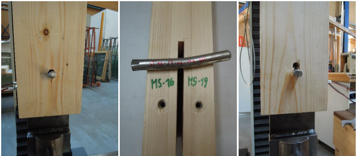
Abbildung ANHANG 6: Bruchbilder ST16-ST-n1-m1-01: links: Seite MS16; rechts: Seite MS19
