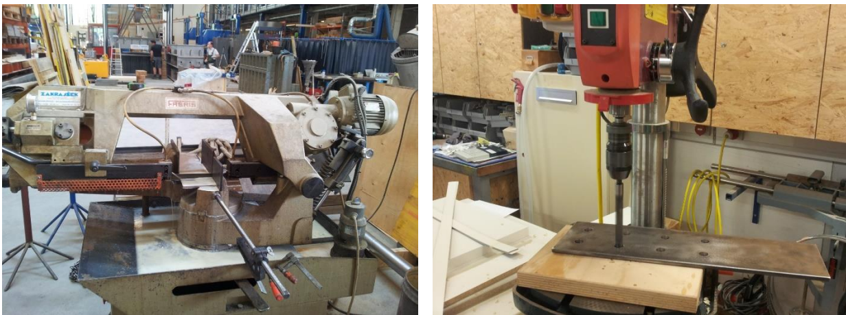
Abbildung 5-30: Herstellen der Schlitzbleche: links: Ablängen des Flachstahls; rechts: Bohren der Löcher
