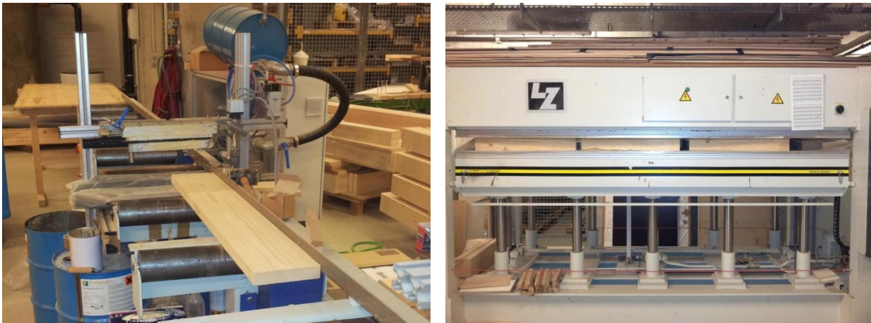
Abbildung 5-26: Kleben der Prüfkörper: links: Klebstoffauftrag; rechts: Verpressen der Lamellen
