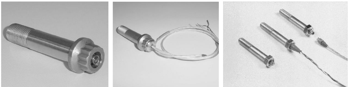
Abbildung 2-8: Messbolzen im Stahlbau – verschiedene Formen [22]
