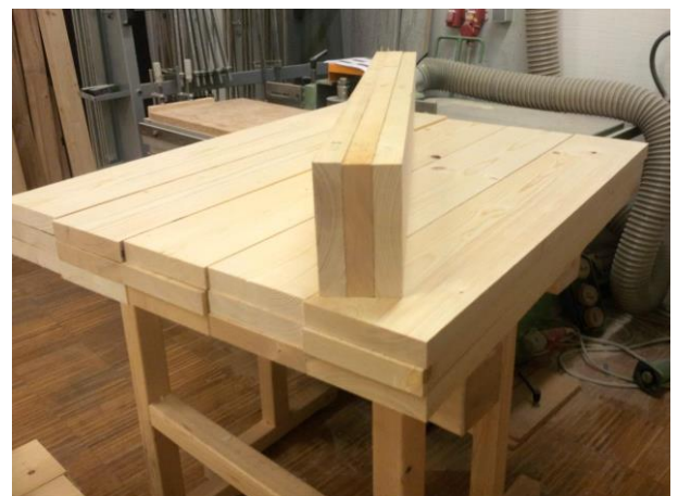
Abbildung 5-25: Formatieren der Prüfkörperlamellen: links: Ablängen der Lamellen auf der Tischkreissäge und Zusammenstellen der BSH-Prüfkörper
