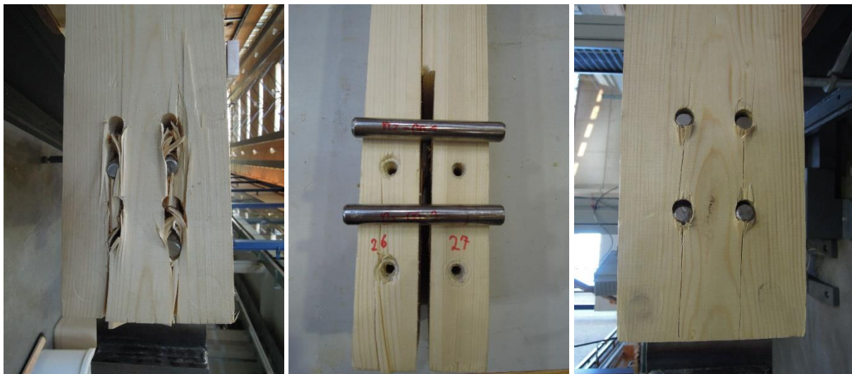
Abbildung ANHANG 79: Bruchbilder ST16-ES-n2-m2-00: links: Seite MS26; rechts: Seite MS27
