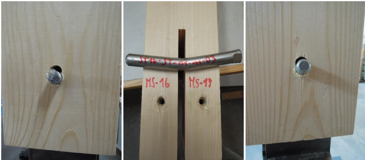
Abbildung ANHANG 12: Bruchbilder ST16-ST-n1-m1-03: links: Seite MS16; rechts: Seite MS19
