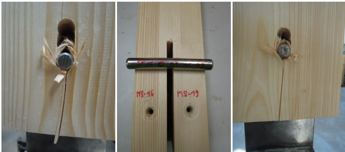
Abbildung ANHANG 31: Bruchbilder ST16-ES-n1-m1-03: links: Seite MS16; rechts: Seite MS19
