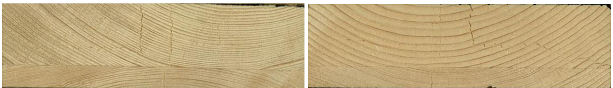
Abbildung ANHANG 61: Jahring-Scan ST16-ES-n5-m1-00: links: Seite MS16; rechts: Seite MS19
