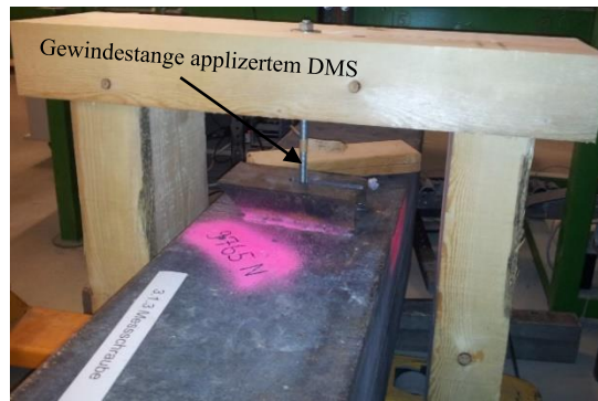
Abbildung 4-21: Kriechversuche verschiedener Klebstoffe – Versuchskonfiguration
