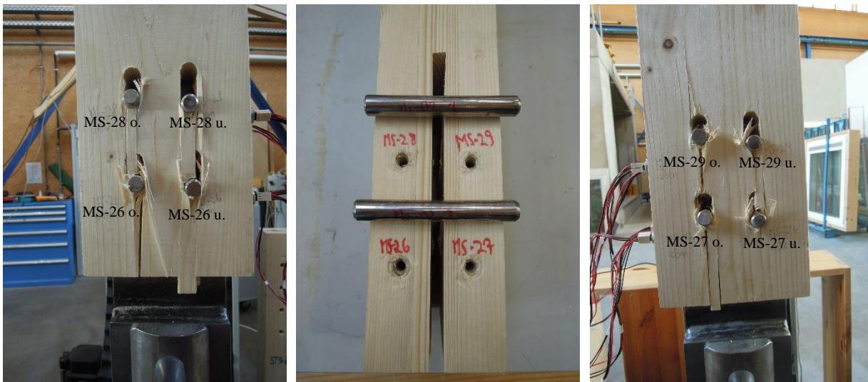
Abbildung 6-25: Bruchbilder der Prüfung ST16-ES-n2-m2-02: links: Seite MS-26; rechts: Seite MS-27
