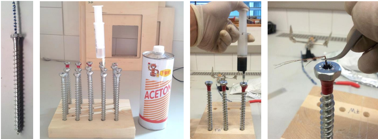
Abbildung 5-39: Applizierung der DMS: links außen: Reinigen der Bohrlöcher mit einer Bürste; links Mitte: Reinigen mit Aceton; rechts Mitte: Einfüllen des Klebstoffs; rechts außen: Einführen des DMS
