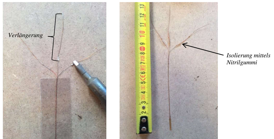
Abbildung 5-37: Verlängerung der DMS-Drähte: links: Anlöten der Verlängerungsdrähte; rechts: elektrische Isolierung der Lötstelle
