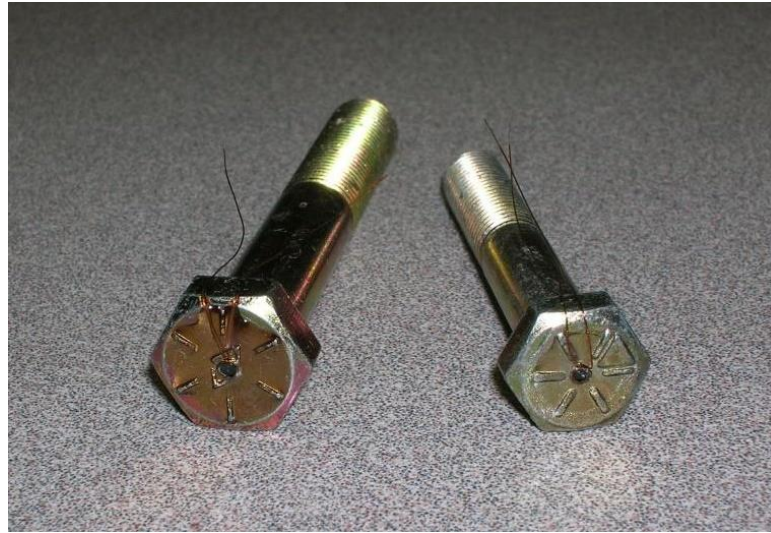
Abbildung 2-6: Messschraube im Stahlbau [5]
