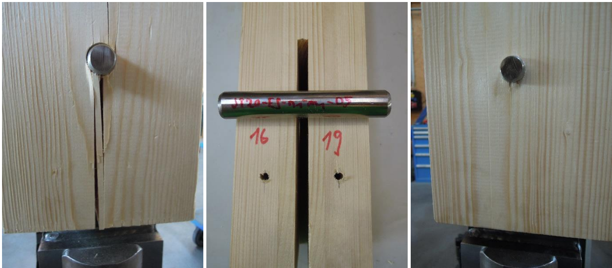
Abbildung ANHANG 56: Bruchbilder ST20-ES-n1-m1-05: links: Seite MS16; rechts: Seite MS19
