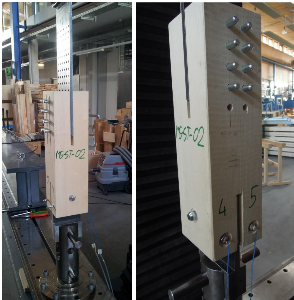
Abbildung 5-3: Durchführung der verstärkten Stabdübel-Tastversuche – Versuchskonfiguration
