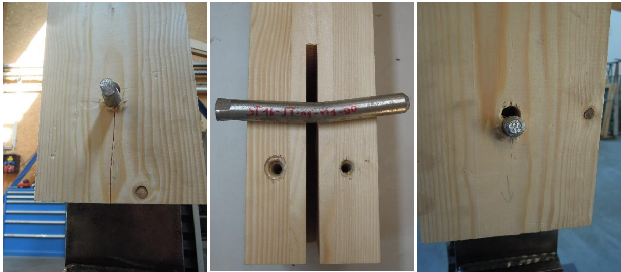
Abbildung ANHANG 3: Bruchbilder ST16-ST-n1-m1-00: links: Seite MS16; rechts: Seite MS19
