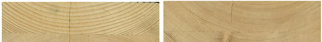
Abbildung 6-12: Jahrring-Scan der Prüfung ST20-ES-n1-m1-02: links: Seite MS-16; rechts: Seite MS-19
