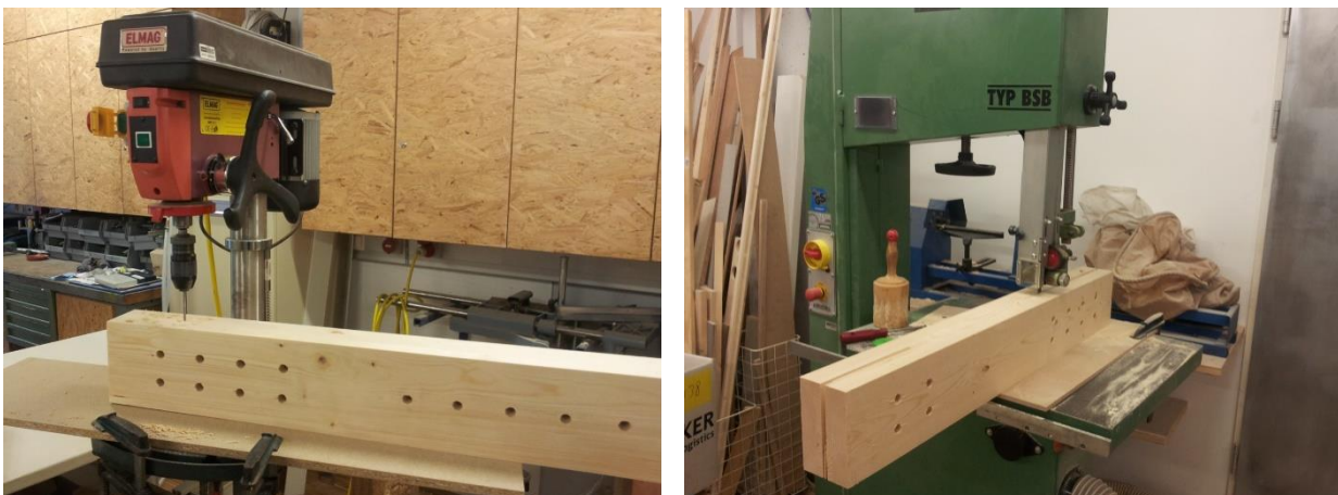
Abbildung 5-27: Bearbeitung der Prüfkörper: links: Bohren der Stabdübellöcher; rechts: Schlitzen mit der Bandsäge
