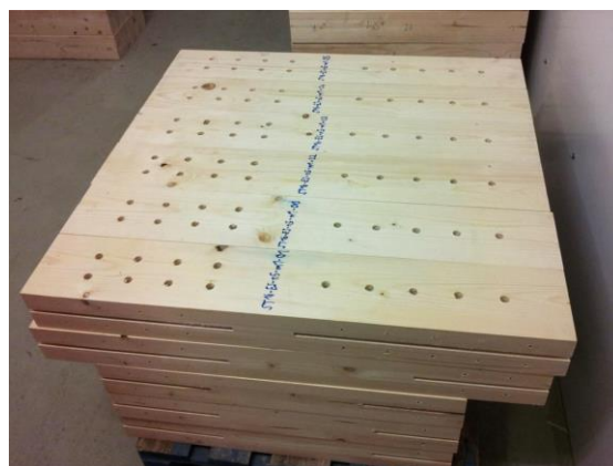
Abbildung 5-28: Beschriftung und Lagerung der Prüfkörper
