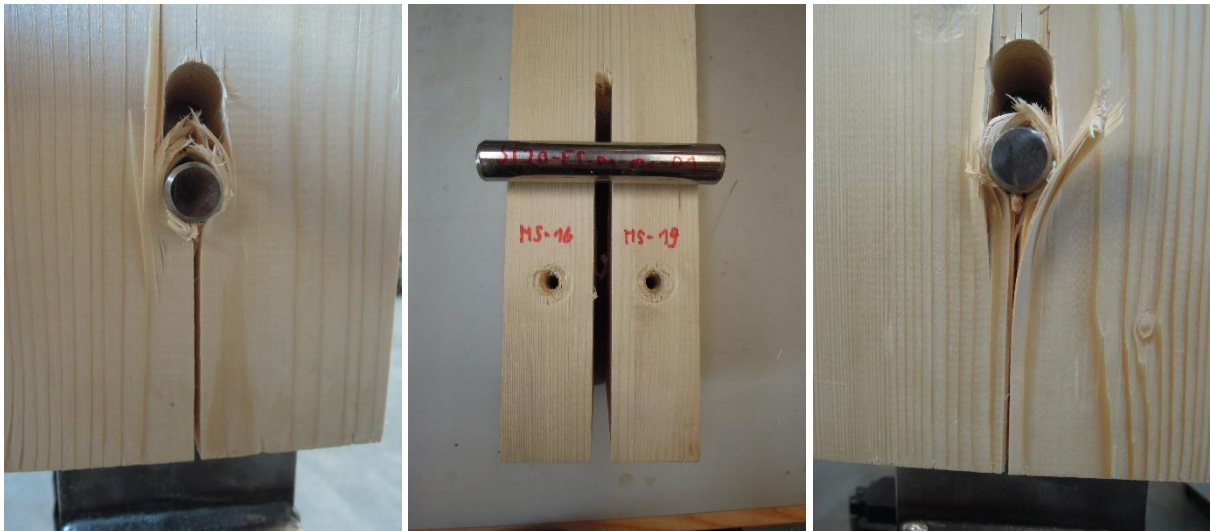
Abbildung ANHANG 44: Bruchbilder ST20-ES-n1-m1-01: links: Seite MS16; rechts: Seite MS19
