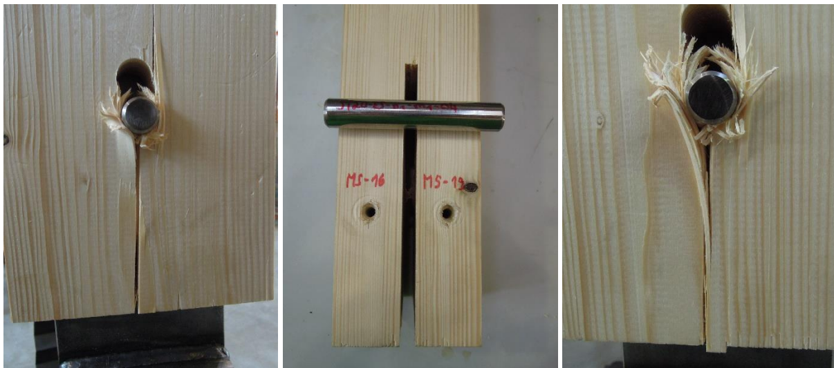
Abbildung ANHANG 53: Bruchbilder ST20-ES-n1-m1-04: links: Seite MS16; rechts: Seite MS19
