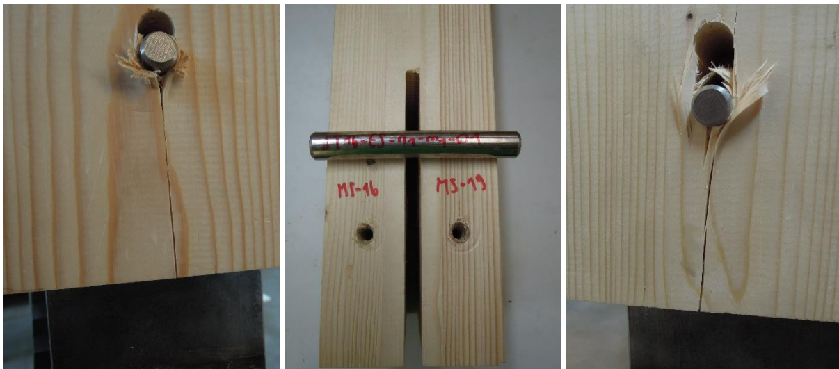
Abbildung ANHANG 25: Bruchbilder ST16-ES-n1-m1-01: links: Seite MS16; rechts: Seite MS19
