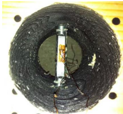
Abbildung 2-20: Zugangslloch zur Messstelle mittels eingebohrtem Loch [45]
