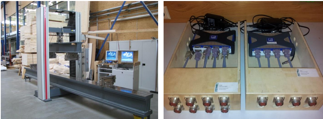
Abbildung 5-58: Universalprüfmaschine und Messverstärker QuantumX MX840A und MX410A
