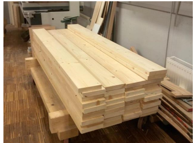
Abbildung 5-24: Hobeln der Lamellen für die Prüfkörper: links: Hobelvorgang; rechts: fertig gehobelte Lamellen
